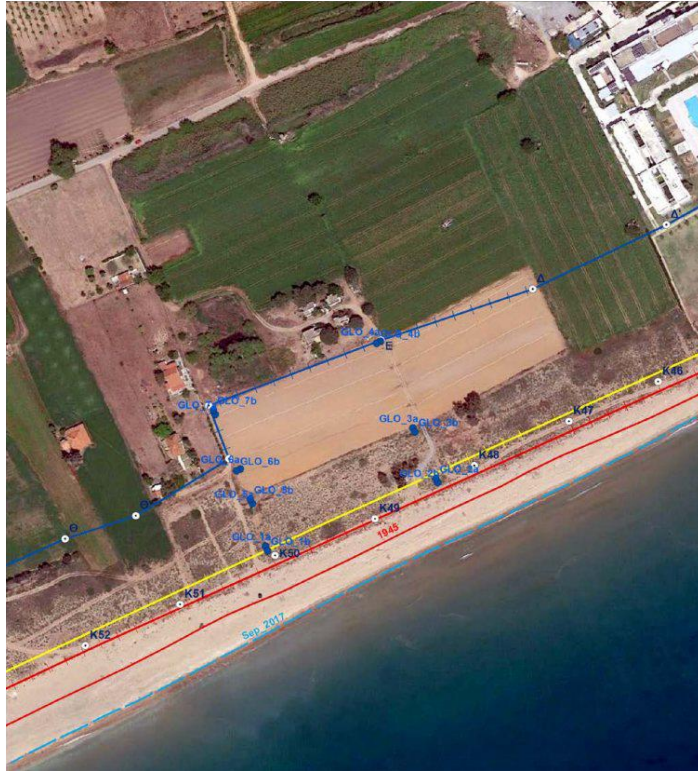
Εικόνα 3.10: Παράδειγμα εσφαλμένης χάραξης παλαιού αιγιαλού (μπλε γραμμή). Με γαλάζια διακεκομμένη γραμμή απεικονίζεται η σημερινή ακτογραμμή, με κόκκινη γραμμή η ακτογραμμή του έτους 1945, με κόκκινη γραμμή με σταυρούς ο αιγιαλός και με κίτρινη γραμμή η παραλία.
