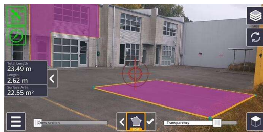
Εικόνα 1-44: Παράδειγμα επαυξημένης πραγματικότητας σε τοπογραφικές εργασίες Πηγή: https://sitevision.trimble.com/blog/the-future-for-cadastral-surveyors-augmented-reality/
