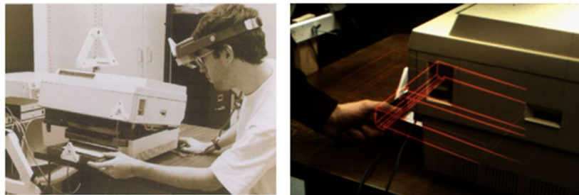
Εικόνα 1-10: Το σύστημα KARMA (αριστερά) και η εικόνα που εμφανίζεται μέσω της συσκευής θέασης
