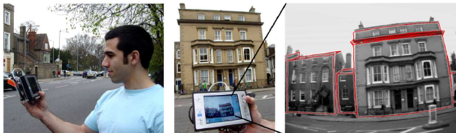
Εικόνα 1-23: Χρήση του συστήματος των Reitmayr και Drummond σε αστικό περιβάλλον (αριστερά). Στιγμιότυπο που εμφανίζει την εικόνα από την ανίχνευση του κτηρίου (κέντρο). Στιγμιότυπο οθόνης με υπέρθεση των ακμών του κτηρίου (δεξιά), Reitmayr and Drummond, 2006
