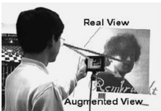
Εικόνα 1-12: Το σύστημα NaviCam (Rekimoto and Nagao 1995)
