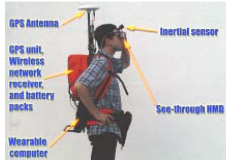
Εικόνα 1-16: Ο πρωτότυπος εξοπλισμός του συστήματος B.A.R.S. (Office of Naval Research, Virginia)
