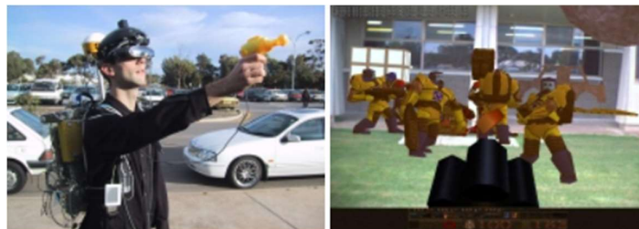
Εικόνα 1-17: Η συσκευή του ARQuake (αριστερά) και στιγμιότυπο από την εικόνα που παρουσιάζεται στον χρήστη (δεξιά)
