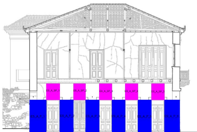
Σχήμα 7.17 - Πεσσοί και υπέρθυρα εσωτερικού τοίχου.
