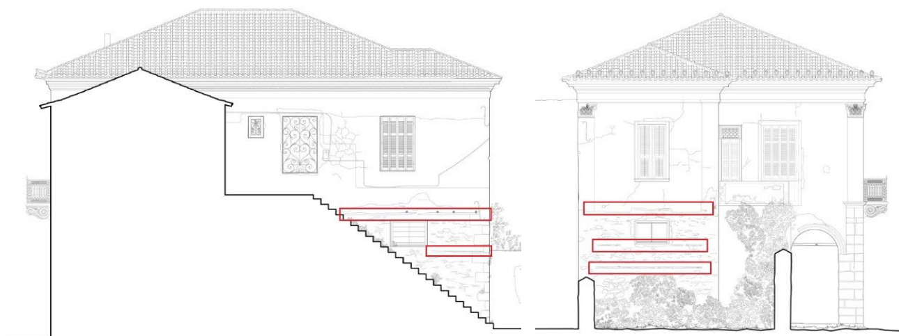
Σχήμα 2.8 - Θέσεις ξύλινων στοιχείων δυτική - νότιας όψης.
