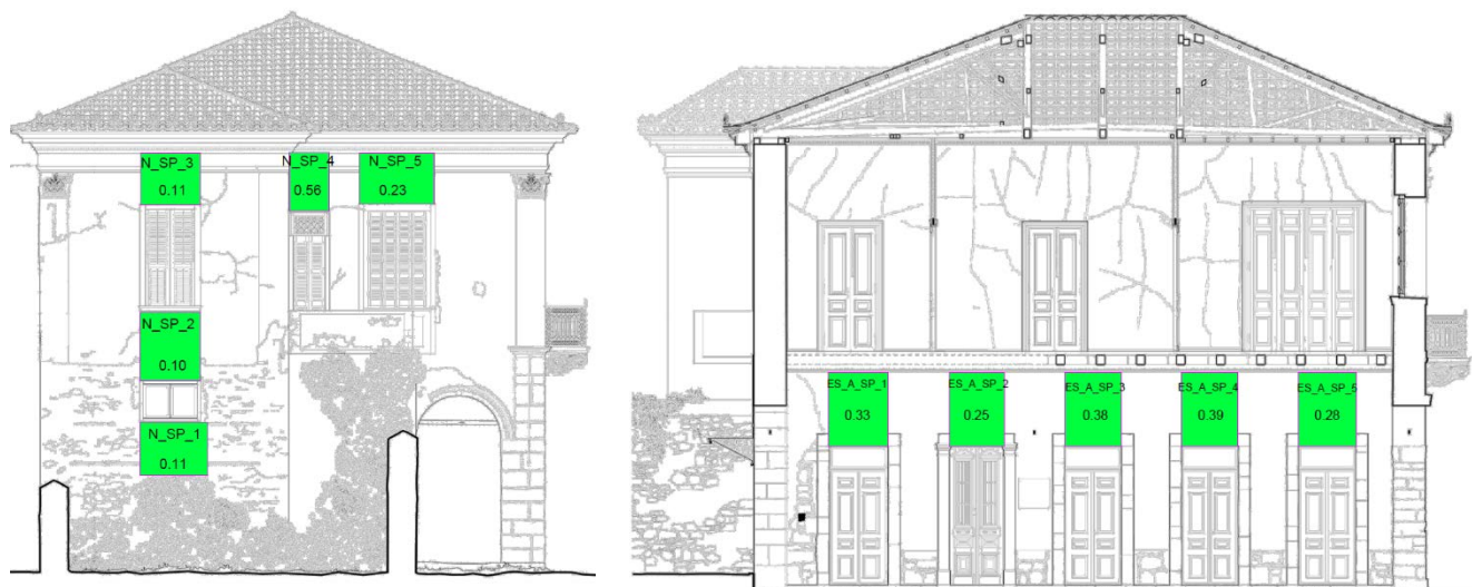
Σχήμα 10.15 - Αποτελέσματα πεσσών νότιου και εσωτερικού τοίχου σε εκτός επιπέδου ροπή περί κατακόρυφο άξονα.
