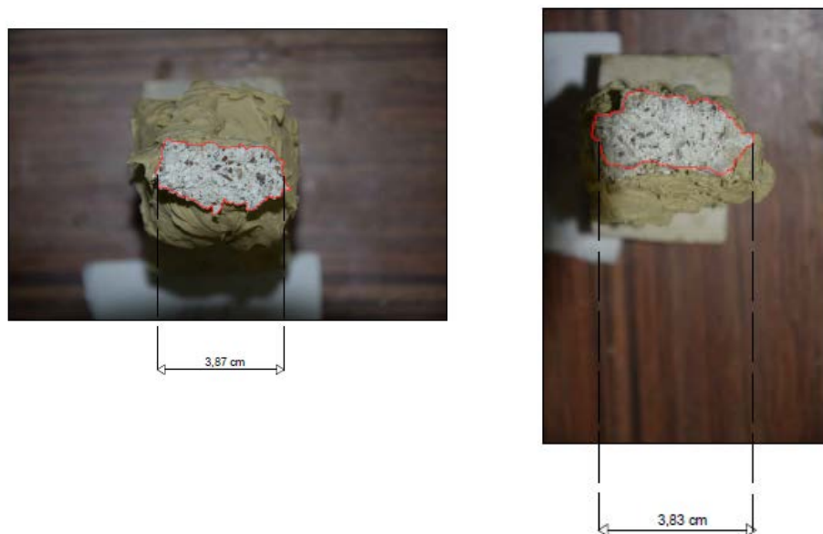
Εικόνα 4.7 - Επιφάνεια θραύσης δοκιμίου K4.
