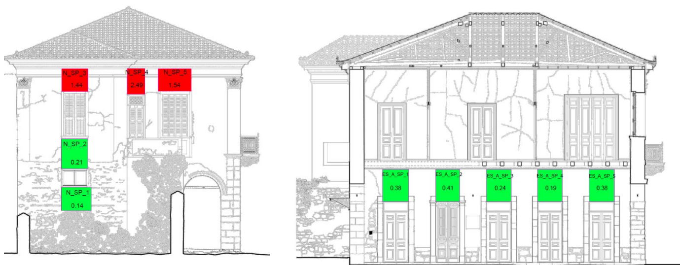
Σχήμα 7.28 - Αποτελέσματα υπερθύρων νότιου και εσωτερικού τοίχου σε εκτός επιπέδου ροπή περί κατακόρυφο άξονα.
