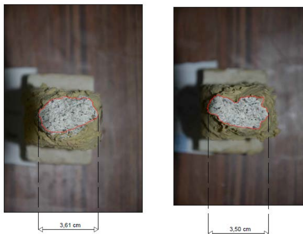
Εικόνα 4.4 - Επιφάνεια θραύσης δοκιμίου K1.
