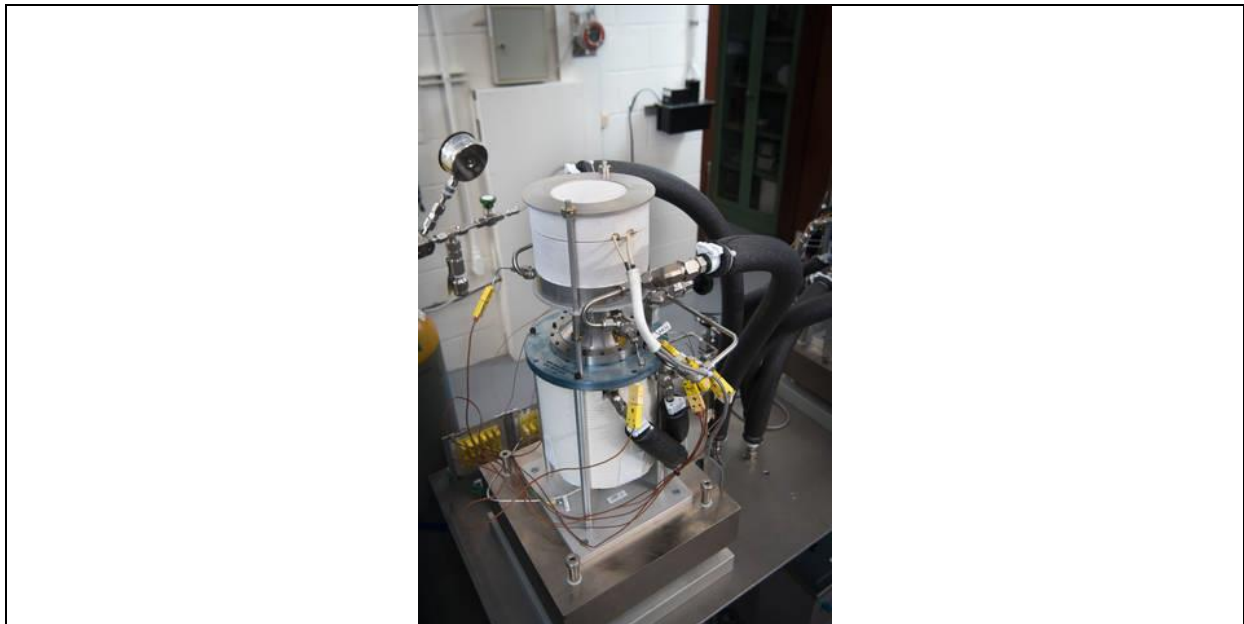
Σχήμα 1.24: Μηχανή Stirling για παραγωγή ηλεκτρικής ενέργειας με χρήση πυρηνικού καυσίμου [16]
