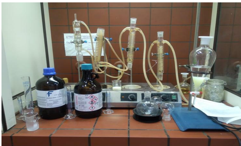
Εικόνα 5.3 : Εξοπλισμός διαδικασίας προσδιορισμού λίπους, Σχολή Χημικών Μηχανικών.
