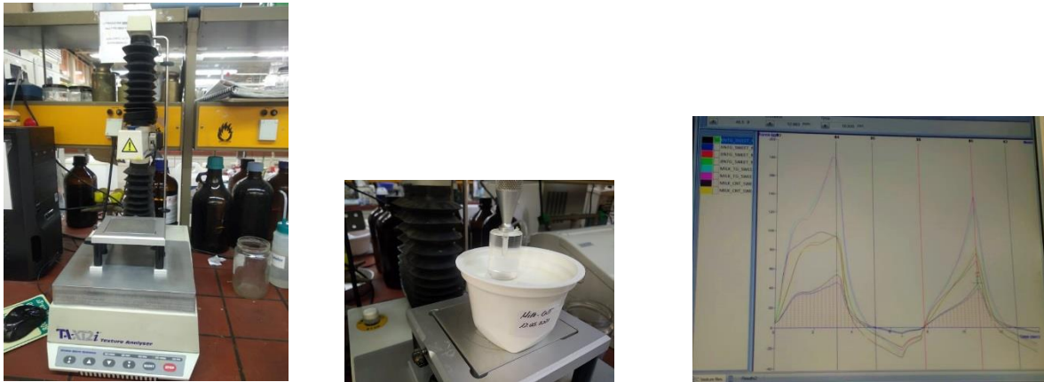
Εικόνα 5.5: Εξοπλισμός και Διαγράμματα αποτελεσμάτων ανάλυσης υφής
