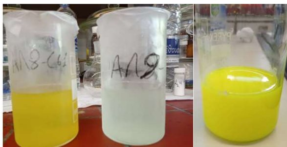
Εικόνα 5.5: Α) Υπερκεείμενα διαλύματα από την φυγοκέντρωση των γαλακτωμάτων της κουμαρίνης-6 (αριστερά), Β) Διπλό γαλάκτωμα κουμαρίνης-6 μετά την εξάτμιση του διαλύτη και πριν την φυγοκέντρωση (δεξιά)
