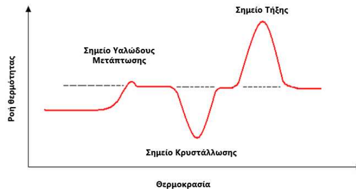
Σχήμα 5.3: Θερμογράφημα DSC ημικρυσταλλικού πολυμερούς
