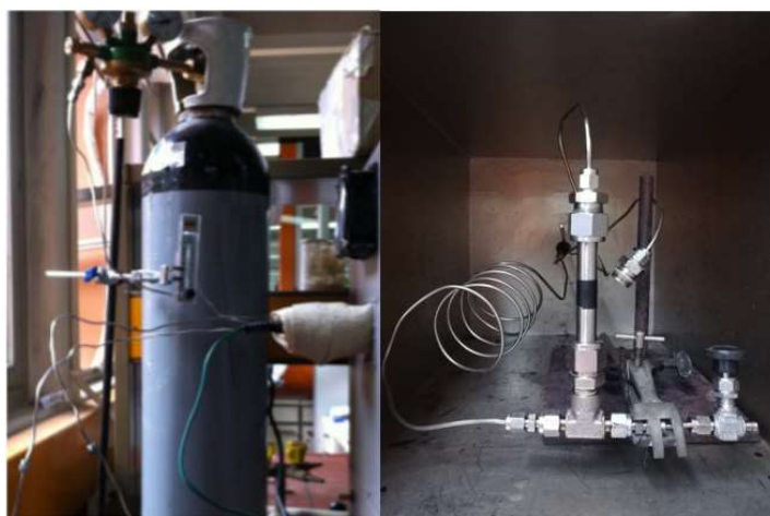
Εικόνα 5.6: Πειραματική διάταξη που χρησιμοποιείται για την διεργασία του πολυμερισμού στερεάς κατάστασης
