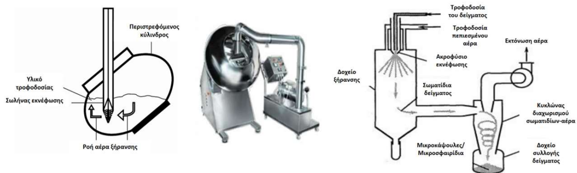
Εικόνα 3.3: Σχηματική αναπαράσταση Α) της συσκευής επικάλυψης σε περιστρεφόμενο κύλινδρο (αριστερά) και Β) της συσκευής ξήρανσης με εκνέφωση (δεξιά)
