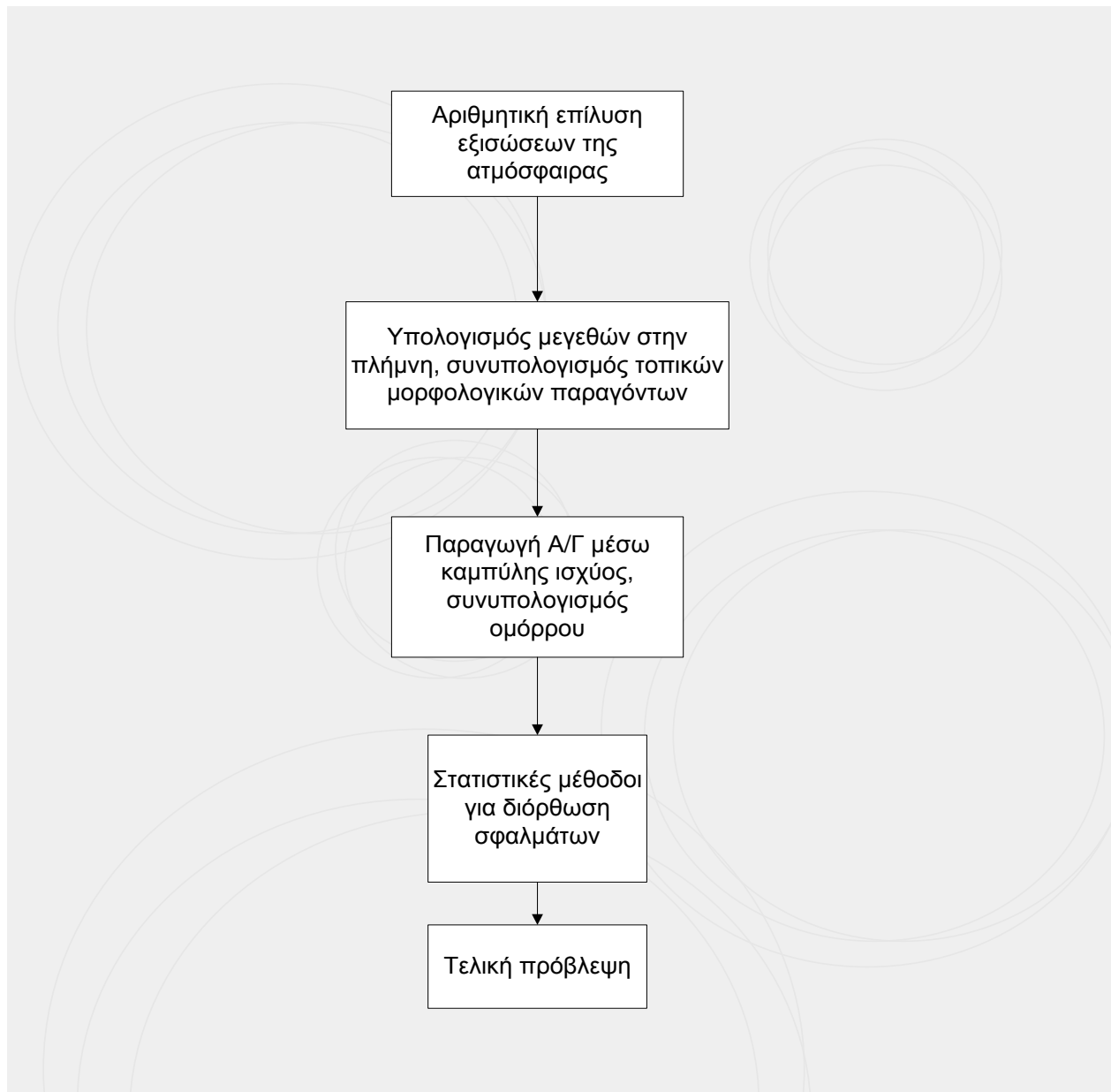
Διάγραμμα 2.7: Υπολογισμός αιολικής παραγωγής μέσω του συστήματος Previento
