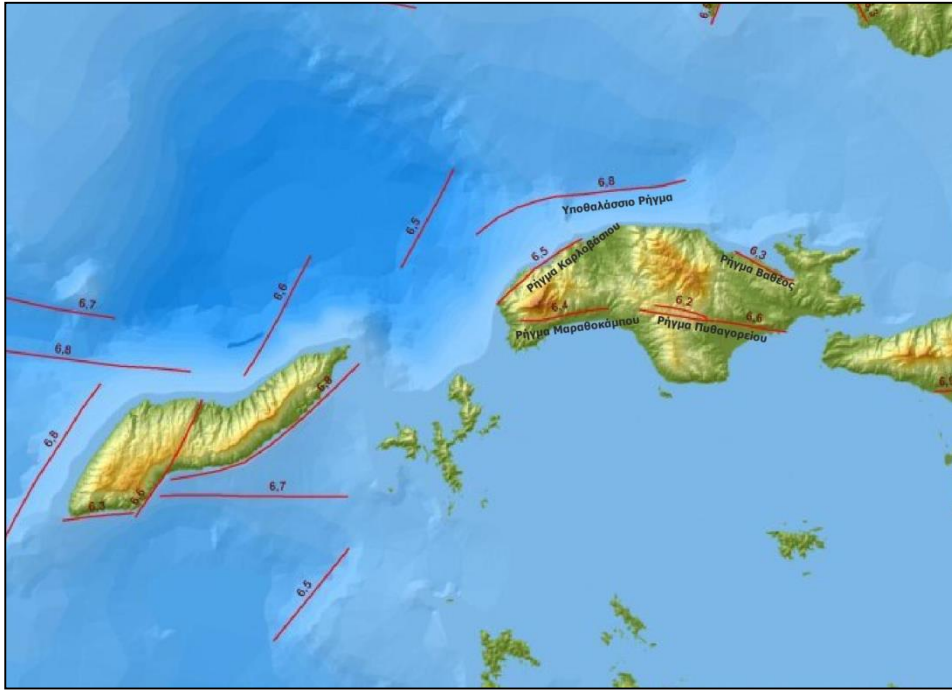
Εικόνα 2.7 Ρήγματα στη Νήσο Σάμο(Πηγή: ethnos.gr, Νοέμβριος 2020)
