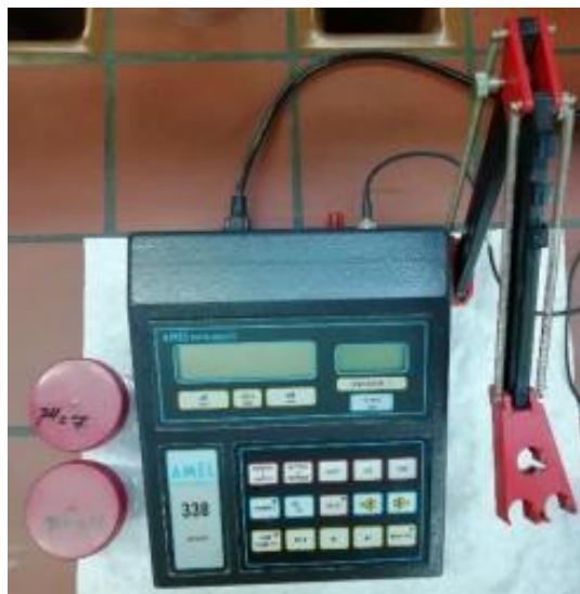
Εικόνα 25: Συσκευή μέτρησης pH, pH meter 338, Amel Instruments.
