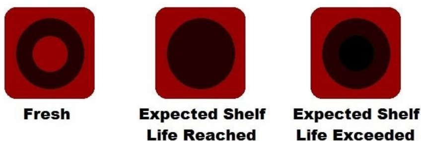
Εικόνα 13: Μεταβολή απόκρισης του πολυμερικού δείκτη Fresh-Check®
