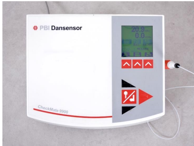
Εικόνα 24: Συσκευή μέτρησης αέριας σύστασης, CheckMate 9900 O 2 /CO 2 , PBI Dansensor.
