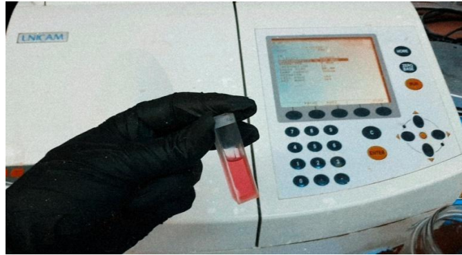
Εικόνα 28: Μέτρηση απορρόφησης του υπερδιηθήματος σε φασματοφωτόμετρο για τον προσδιορισμό της οξείδωσης λιπαρών οξέων.
