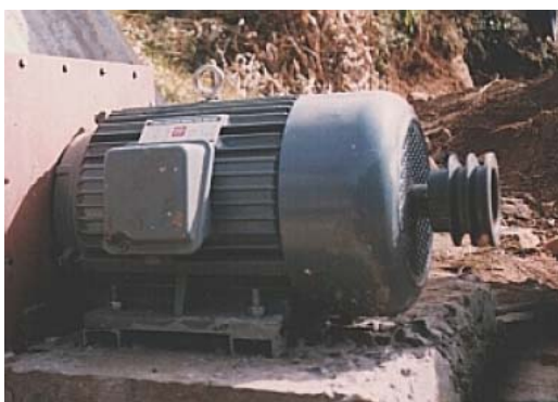
Σχήμα 1.30: Τριφασικός επαγωγικός κινητήρας σε ρόλο γεννήτριας
