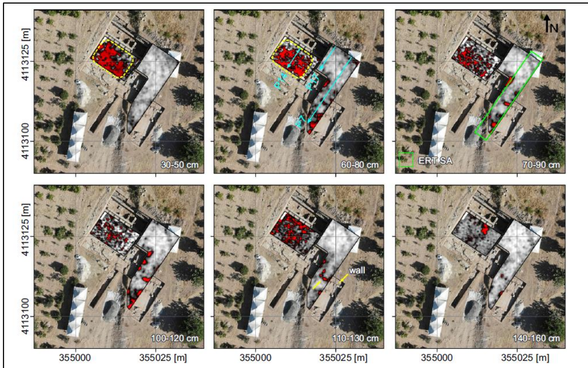
Εικόνα 3.24: Οι χάρτες βάθους GPR που ελήφθησαν από το SA-3 επικαλύπτονται στην εικόνα του drone.
