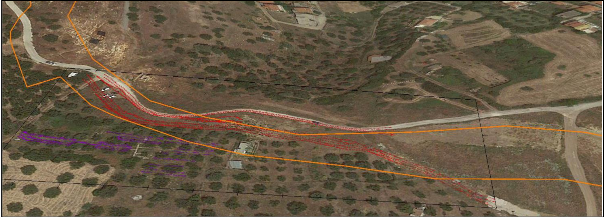
Εικόνα 5.27: Χάρτης Google Earth της περιοχής έρευνας κοντά στο Πεταλίδι όπου με καφέ περιγράφεται η περιοχή ενδιαφέροντος και φαίνονται επίσης οι μετρήσεις γεωραντάρ (με κόκκινο για βάθος διασκόπησης 8μ, με μωβ για βάθος 4μ).
