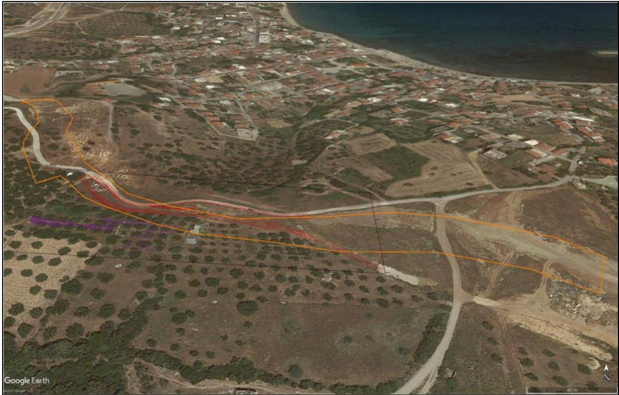
Εικόνα 5.3: Χάρτης Google Earth της περιοχής έρευνας κοντά στο Πεταλίδι όπου με καφέ περιγράφεται η περιοχή ενδιαφέροντος και φαίνονται επίσης οι μετρήσεις γεωραντάρ (με κόκκινο, έως βάθος 6μ, με μωβ έως βάθος 3μ)
