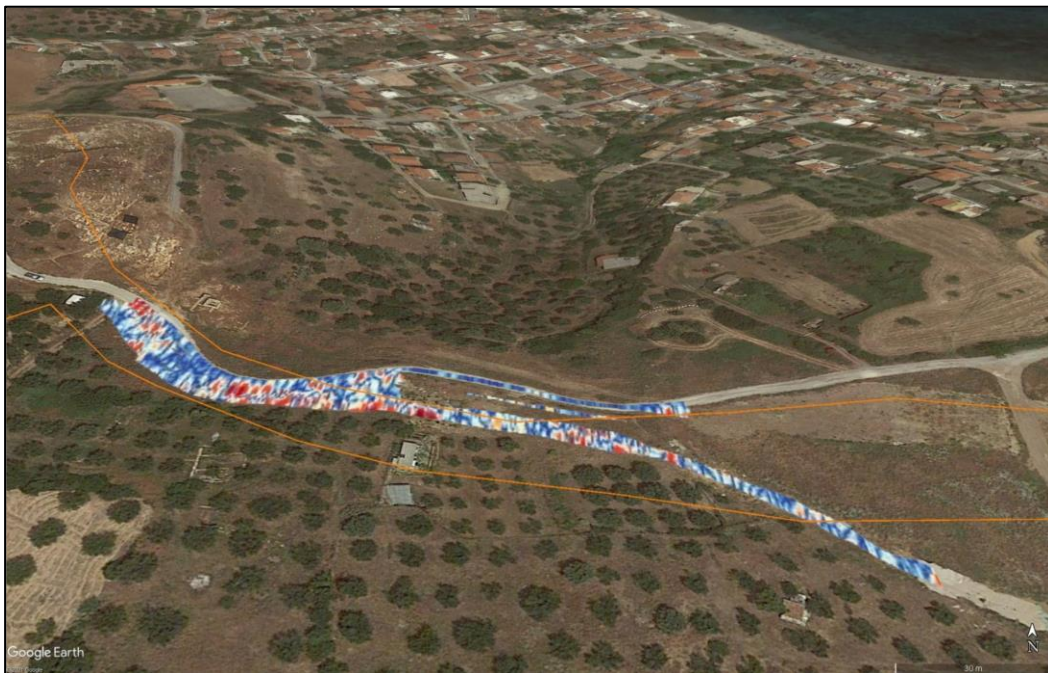
Εικόνα 5.30: Οριζόντια τομή γεωραντάρ αποτύπωσης μεγέθους πλάτους ανάκλασης με διαφορετικό λογισμικό απ' ότι προηγούμενα για βάθος 3μ όπου οι κόκκινες αποχρώσεις μας δείχνουν θέσεις δομών που δημιουργούν τοπικές ισχυρές ανακλάσεις και μπορεί να σχετίζονται με θέσεις αρχαίων τοιχίων. Η τομή γεωραντάρ έχει αποτεθεί επάνω στο Google Earth χάρτη.
