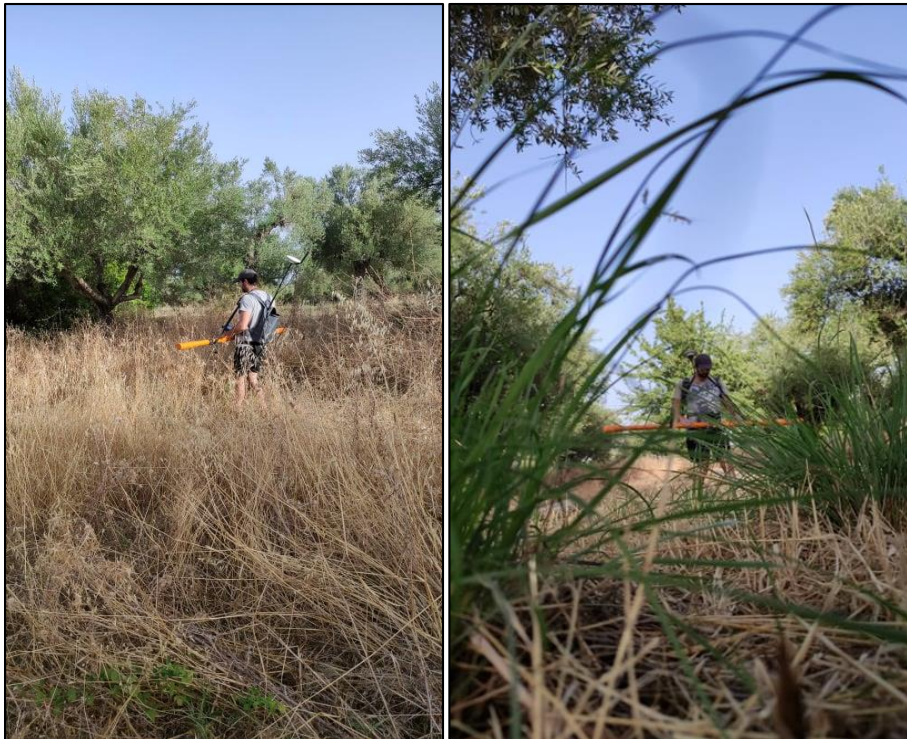
Εικόνα 5.4: Ηλεκτρομαγνητικές μετρήσεις επαγωγής με CMD-2 για συνολικό βάθος 3μ.
