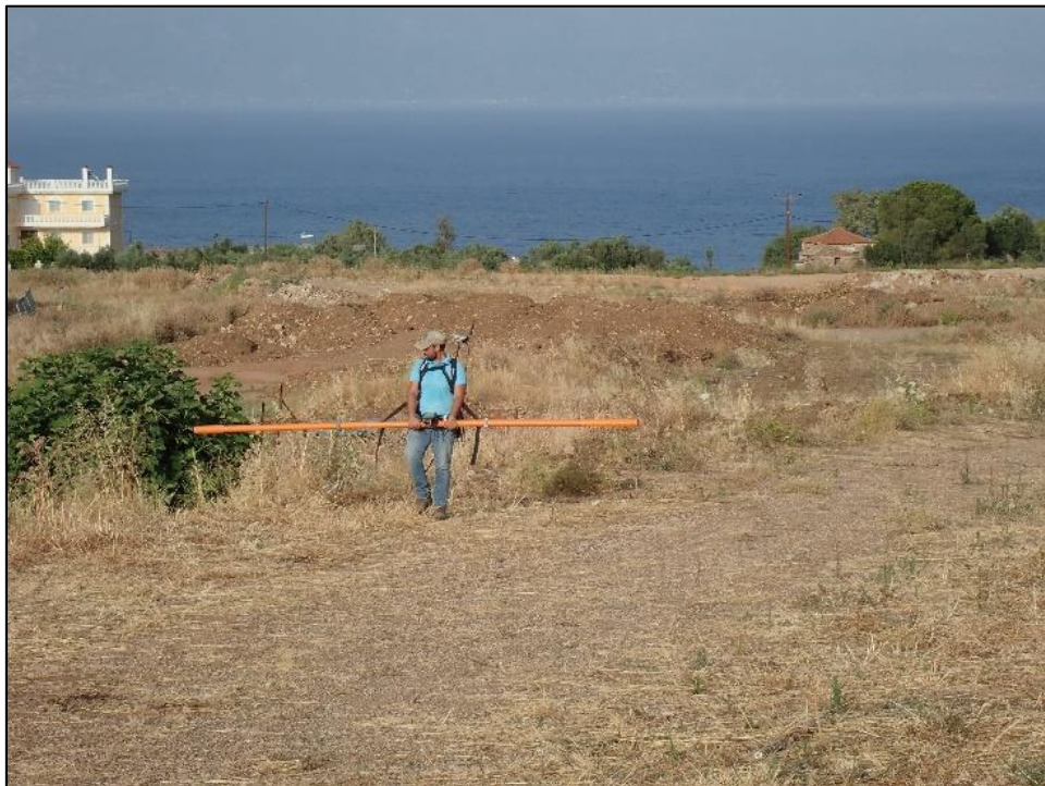
Εικόνα 5.5 : Ηλεκτρομαγνητικές μετρήσεις επαγωγής με CMD-4 για συνολικό βάθος 6μ.
