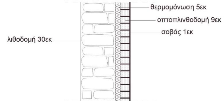
λεπτομέρεια πέτρινου τοίχου κτιρίου Γ κλίμακα 1:10
