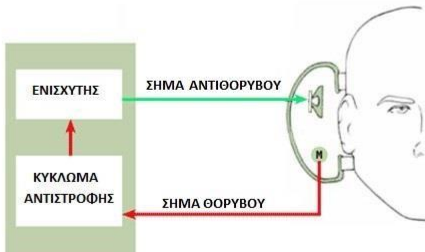
Εικόνα 1.1: Βασική αρχή του noise cancellation: καταγραφή του θορύβου με χρήση μικροφώνου, αντιστροφή του και πρόσθεσή του στο αρχικό ηχητικό σήμα για αλληλοεξουδετέρωση. (Πηγή εικόνας: David Clark Company)
