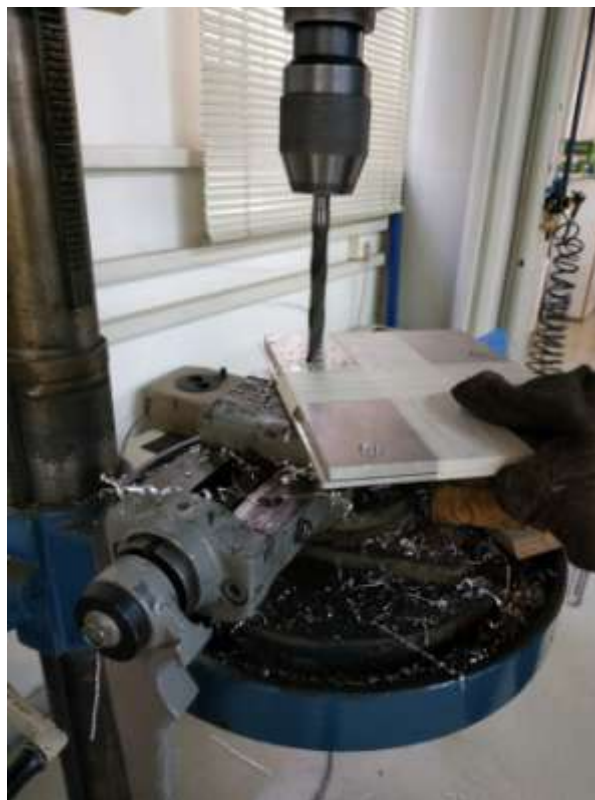
Εικόνα 13: Δημιουργία οπών στα ελάσματα για την πάκτωσή τους στη μηχανής συγκόλλησης FSW
