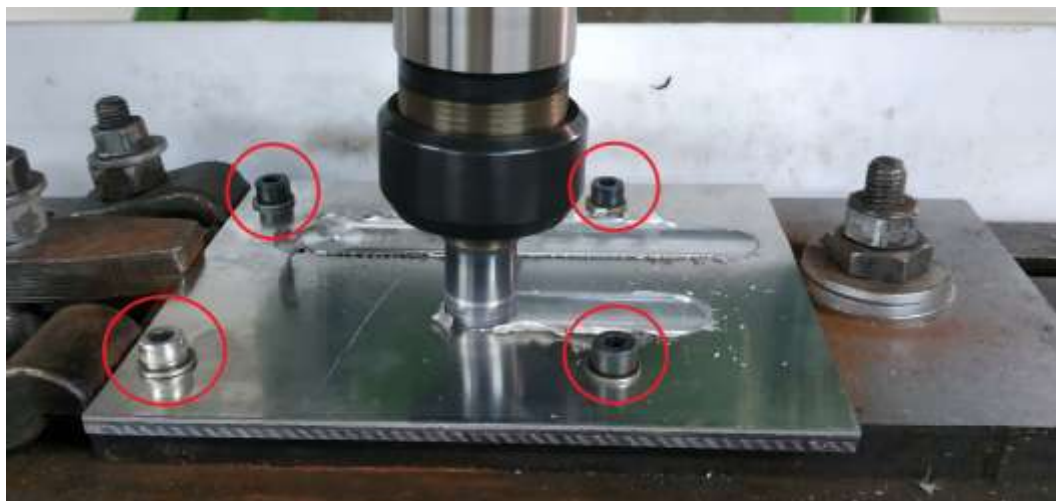
Εικόνα 15: Σημεία πάκτωσης ελασμάτων κατά την συγκόλληση FSW
