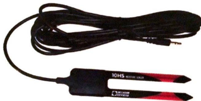
Εικόνα 17. Αισθητήρας μέτρησης της υγρασίας του εδάφους μέσω της διηλεκτρικής σταθεράς του [1]
