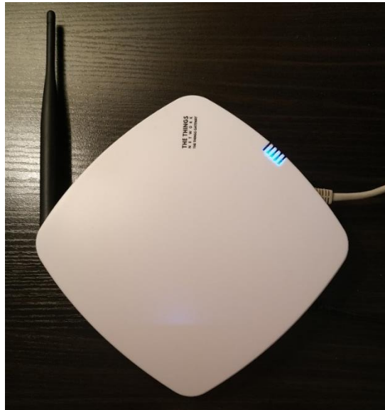
Εικόνα 89. Η συσκευή gateway συνδεδεμένη με καλώδιο LAN
