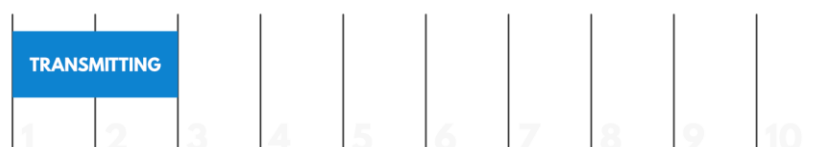
Εικόνα 73. Παράδειγμα 20 % duty cycle [54]
