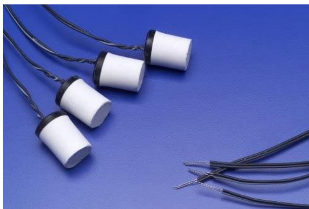
Εικόνα 14. Κύβοι γύψου που χρησιμοποιούνται ως αισθητήρες μέτρησης της υγρασίας του εδάφους [1]
