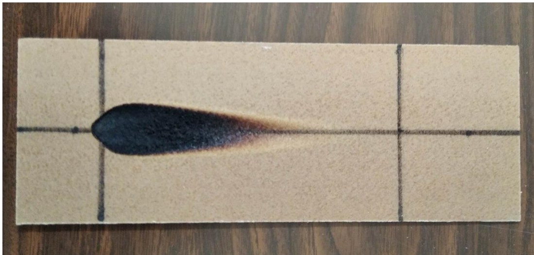
Σχήμα 6.3 Δοκίμιο 1b.1 μετά το πέρας της δοκιμής
