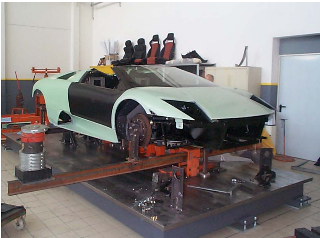
Τυπική δοκιμή μετρήσεως της στρεπτικής δυσκαμψίας οχήματος
