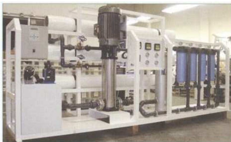
Εικόνα 10 Τυπική compact μονάδα αντίστροφης όσμωσης (Πηγή: ECOTECH ΕΠΕ)
