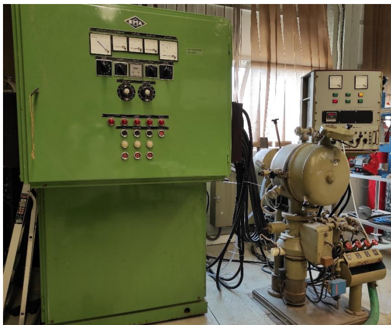
Εικόνα 12. Η βασική διάταξη του επαγωγικού φούρνου στο Εργαστήριο Πυρομεταλλουργίας.
