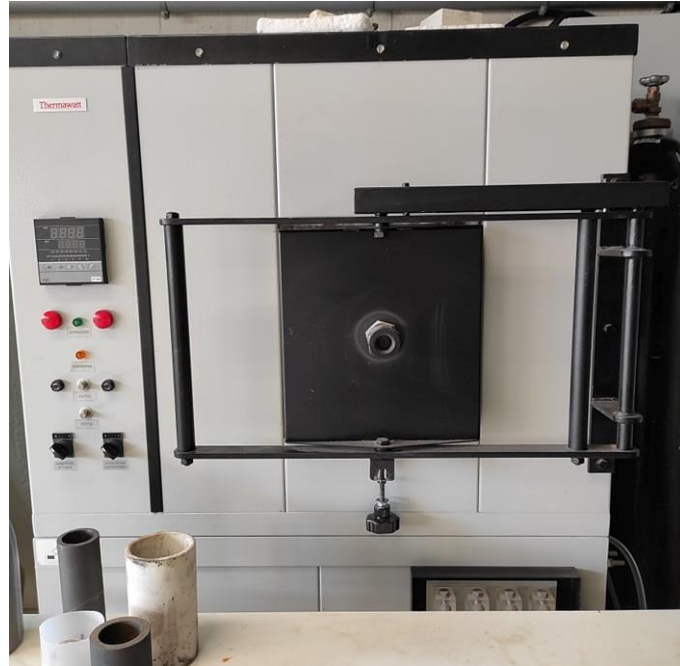
Εικόνα 19. Ο φούρνος αντιστάσεων του Εργαστηρίου Πυρομεταλλουργίας που χρησιμοποιήθηκε στα πειράματα.
