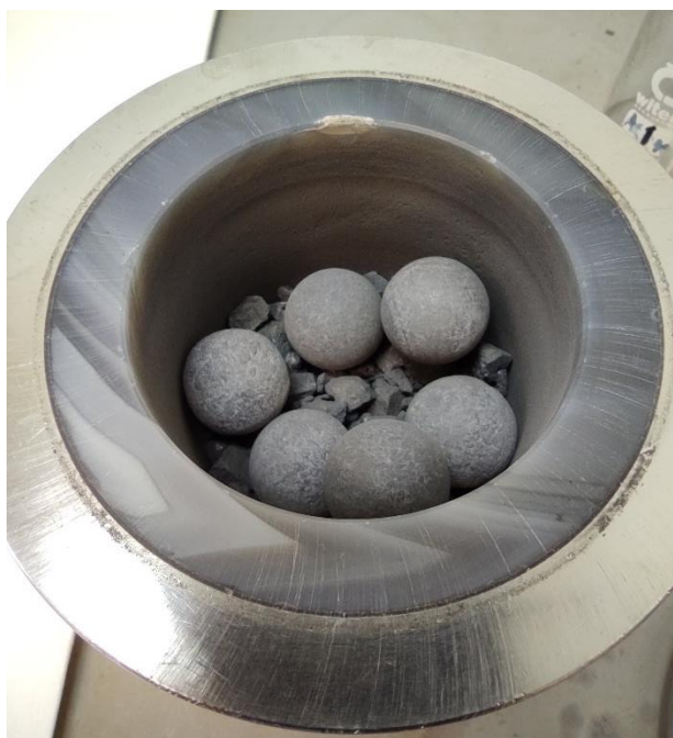
Εικόνα 21. Το δείγμα στο δοχείο με τις αχάτινες σφαίρες πριν τη λειοτρίβηση.
