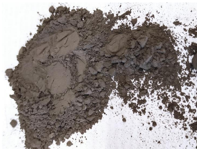
Εικόνα 22. Το δείγμα μετά το στάδιο της λειοτρίβησης.
