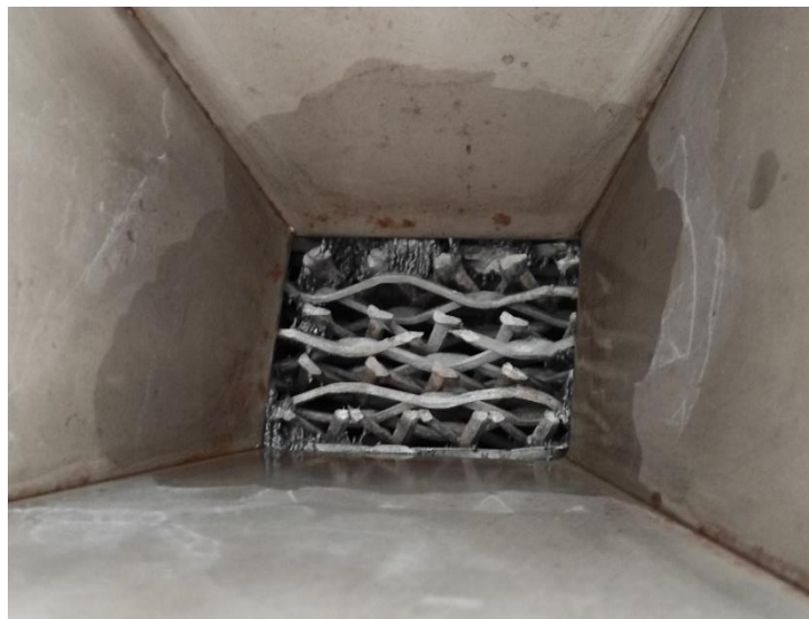
Εικόνα 24. Το μέσο διαχωρισμού με πλέγματα και οι μαγνητικοί κόκκοι του υλικού.
