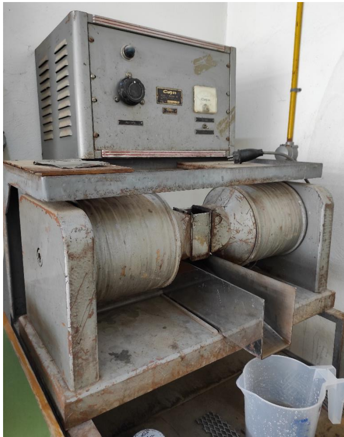
Εικόνα 23. Υγρός μαγνητικός διαχωριστής υψηλής έντασης στο Εργαστήριο Εμπλουτισμού Μεταλλευμάτων.
