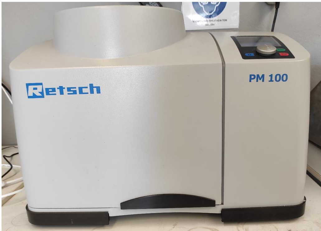
Εικόνα 20. Ο σφαιρόμυλος στον οποίο πραγματοποιήθηκε η λειοτρίβηση.
