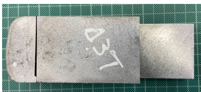
Εικόνα 26: Χυτό τετράγωνης γεωμετρίας 3 ης χύτευσης, το οριζόντιο κατώτερο τμήμα επιλέχθηκε για μακροπροσβολή.
