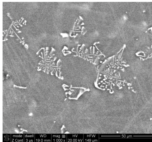
Εικόνα 14: Μικροδομή κράματος MgAl_2Si και Mg_2Si φάση μορφολογίας Chinese script [59].
