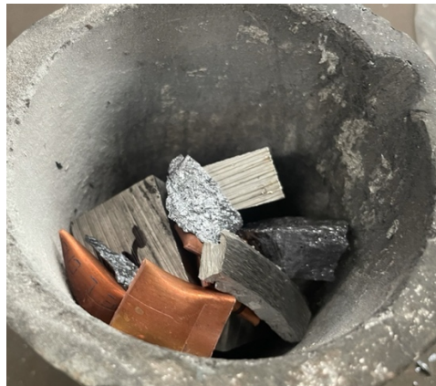
Εικόνα 16: Πρώτη ύλη εντός του καλουπιού.
