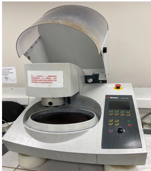
Εικόνα 25: Αυτόματο λειαντικό Struers Tergamin-30.
