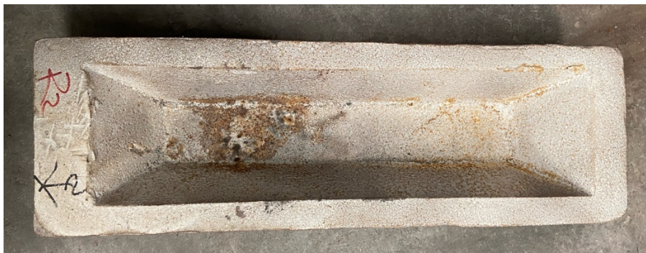
Εικόνα 17: Καλούπι μακρόστενης γεωμετρίας 1 ης & 2 ης χύτευσης.
