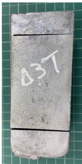
Εικόνα 23: Χυτό block προερχόμενα από την 3 η δοκιμή χύτευσης.
