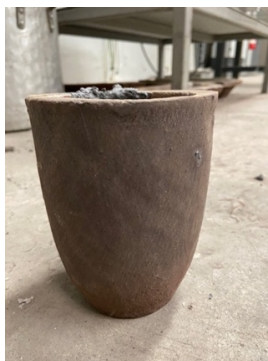
Εικόνα 18: Καλούπι κυλινδρικής γεωμετρίας που χρησιμοποιήθηκε κατά την τήξη της πρώτης ύλης.
