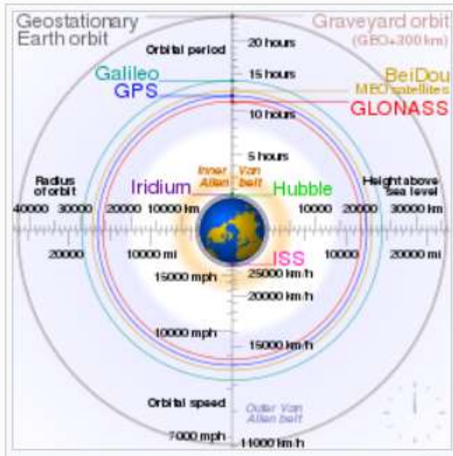
Εικόνα 1.1-1 Τροχιακά επίπεδα των GNSS
