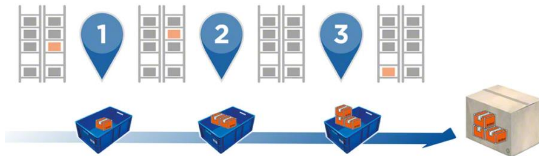
Σχήμα 3.2: Σχηματική αναπαράσταση του τρόπου συλλογής παραγγελιών «pick-and-pass» σε αποθήκες όπου εφαρμόζεται το zone picking. (Interlake Mecalux, 2021)
