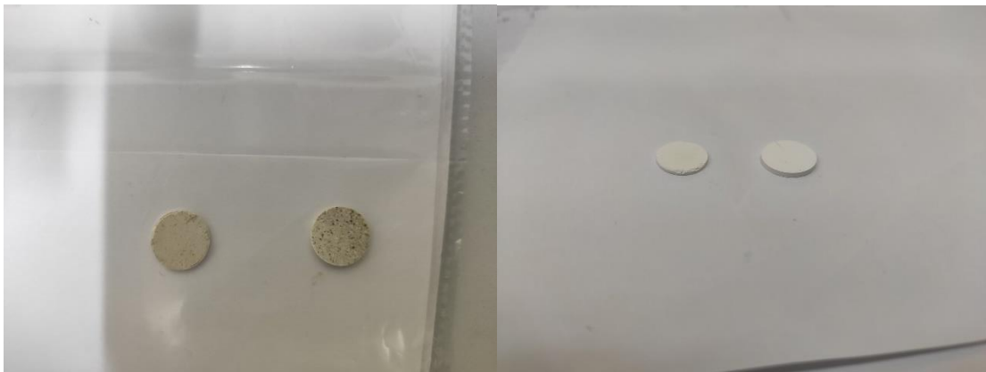
Εικόνα 2—15 (A-B): Δοκίμια σειράς 4, 5 (από αριστερά προς τα δεξιά) μετά από έψηση στον 2 ο (1200 °C) και 1 ο (1300 °C) κύκλο πυροσυσσωμάτωσης.
