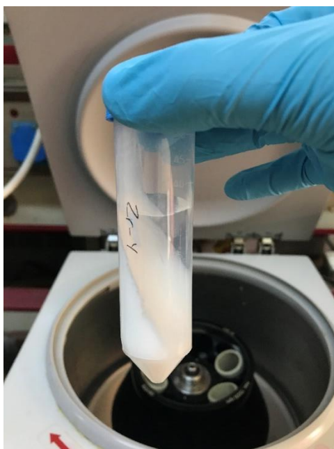
Εικόνα 2—5: Διαχωρισμός νερού-σκόνης από το κεραμικό μετά την παραμονή του σωληνάριου στη φυγόκεντρο.
