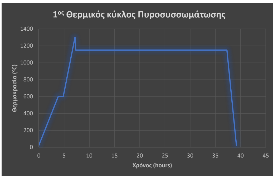
Διάγραμμα 2—3: Διάγραμμα θερμοκρασίας-χρόνου 1 ου θερμικού κύκλου πυροσυσσωμάτωσης.
