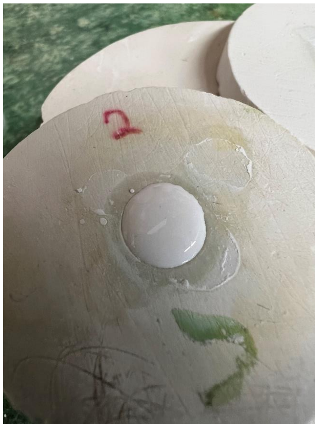
Εικόνα 2—11: Το καλούπι που χρησιμοποιήθηκε μαζί με το αιώρημα της περίπτωσης 2 (35% κατά βάρος σκόνης Ζιρκονίας).
