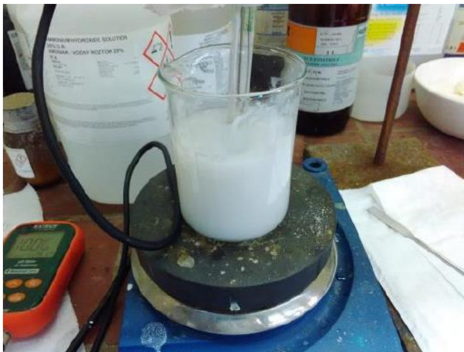
Εικόνα 2—3: Τελικό στάδιο (pH=10) Διαδικασίας καταβύθισης.
