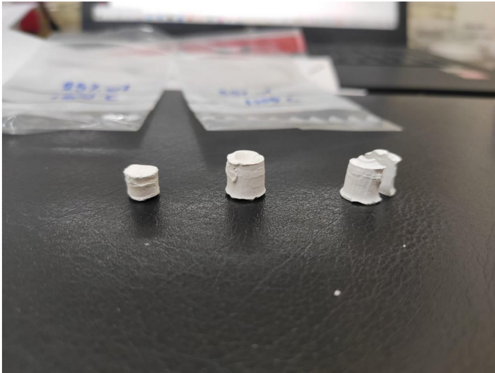
Εικόνα 2—14: Δοκίμια σειράς 1, 2 και 3 (από αριστερά προς τα δεξιά) μετά από έκθεση στον 2 ο κύκλο πυροσυσσωμάτωσης (1200 °C).
