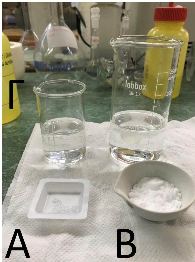
Εικόνα 2—2: Τα Πρόδρομα αντιδραστήρια που χρησιμοποιήθηκαν και ο διαλύτης : A) \text{Y}(\text{NO}_3)_3 \cdot \text{H}_2\text{O} B) \text{N}_2\text{O}_7\text{Zr} \cdot \text{xH}_2\text{O} Γ) \text{H}_2\text{O}
