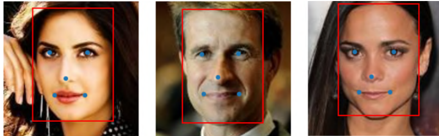
Σχήμα 3.2: Εξαγωγή σημείων ενδιαφέροντος (5 σημαντικότερων) και πλαισίων οριοθέτησης προσώπων, με χρήση του MTCNN face detector.
