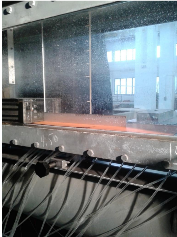
Εικόνα 4.15 Βαθμονόμηση της κάμερας CCD με την χρήση κανόνα και της βοηθητικής διάταξης.
