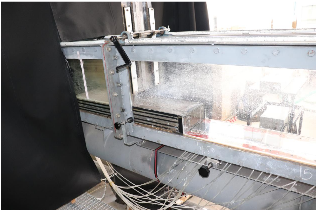
Εικόνα 4.5 Καταβαθμός οξείας αιχμής μήκους 1 m και ύψους 10.3 cm όπου φαίνονται οι τρεις πιεζομετρικές οπές στο μέτωπο και οι σωλήνες από τα πιεζόμετρα στον πυθμένα της διώρυγας.
