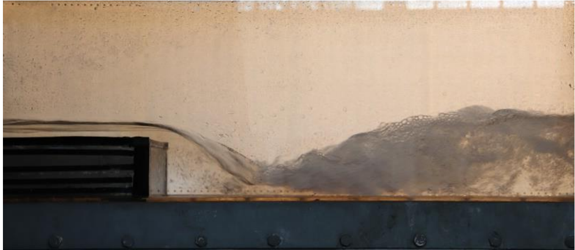
Εικόνα 1.1 Υπερκρίσιμη ροή ανάντη, υποκρίσιμη ροή κατάντη, minimum B jump (υδραυλικό άλμα στον πόδα της πτώσης).
