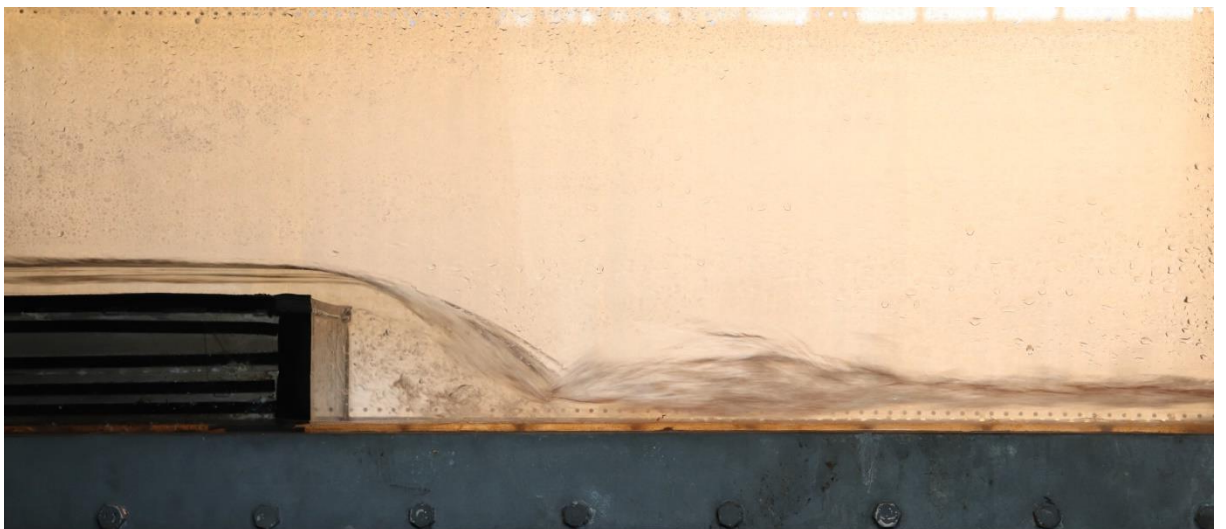
Εικόνα 1.6 Υπερκρίσιμη ροή ανάντη και κατάντη του καταβαθμού.
