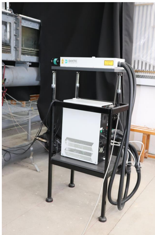
Εικόνα Α.2 Laser Nd:YAG εκπομπής πράσινου φωτός και μέγιστης ενέργειας 135 mJ.
