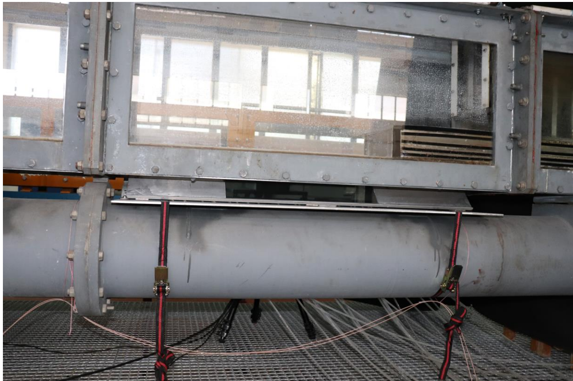
Εικόνα 4.8 Καθρέπτης υψηλού ποσοστού ανάκλασης και διάταξη στήριξής του.
