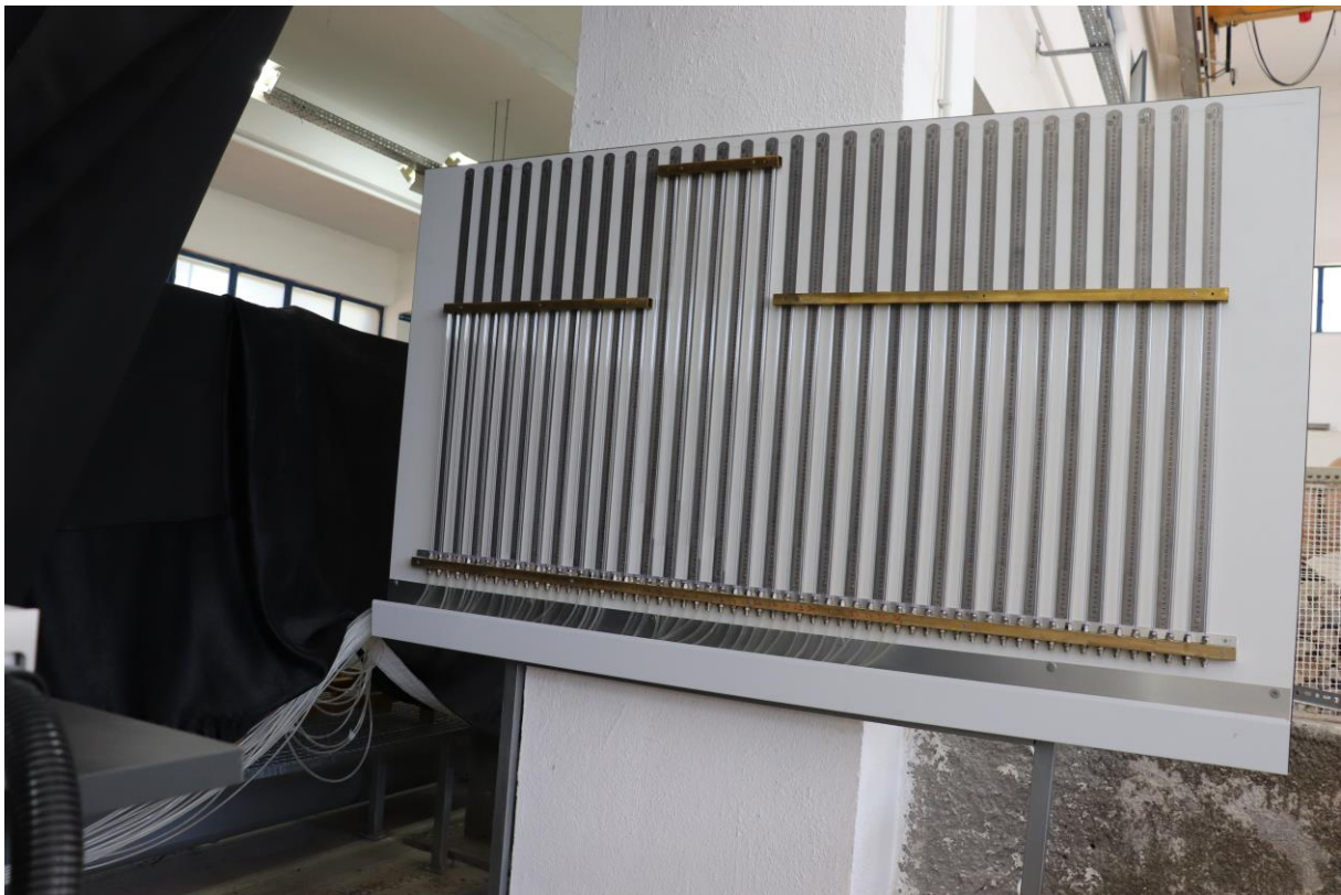
Εικόνα 4.6 Πίνακας πιεζομετρικών σωλήνων για την μέτρηση του ύψους πίεσης ανάντη, κατόντη και στο μέτωπο του καταβαθμού (κάλυψη περιοχής υδραυλικού άλματος).
