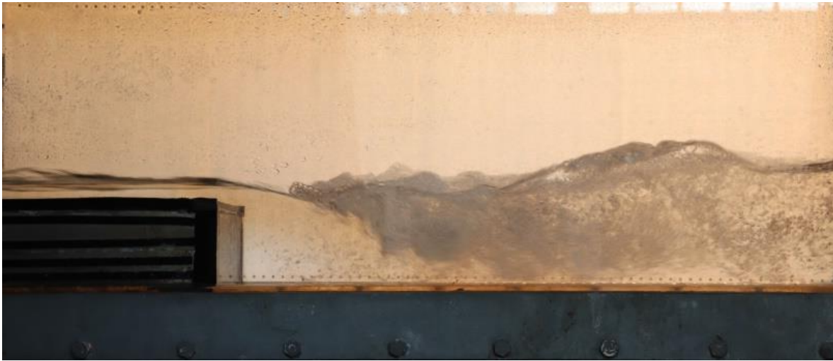
Εικόνα 1.2 Υπερκρίσιμη ροή ανάντη, υποκρίσιμη ροή κατάντη, B jump (βυθισμένο υδραυλικό άλμα).
