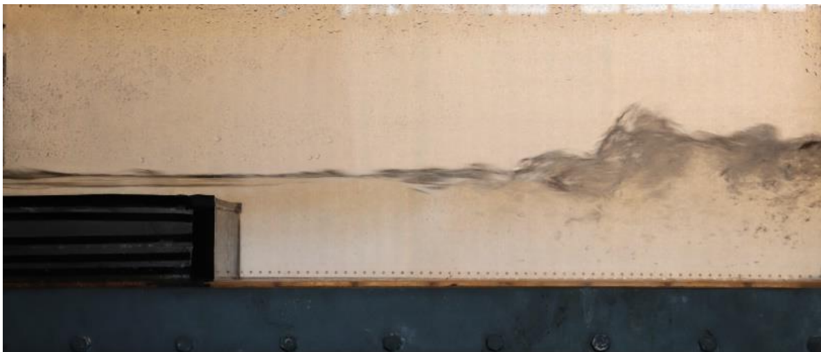
Εικόνα 1.3 Υπερκρίσιμη ροή ανάντη, υποκρίσιμη ροή κατάντη, Wave train.
