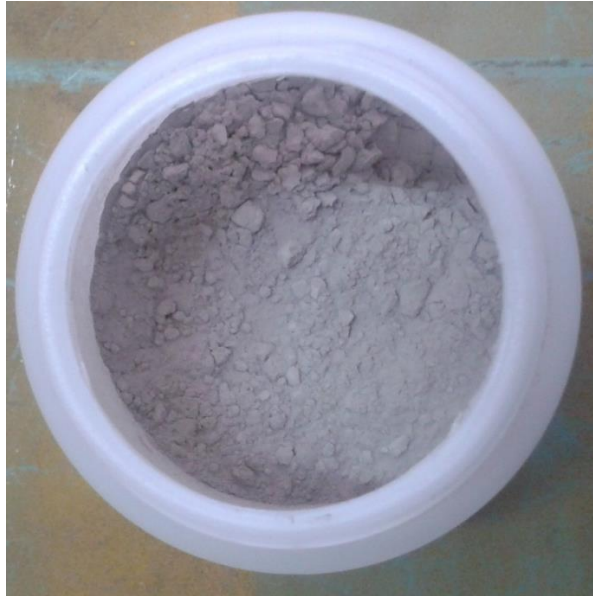
Εικόνα A.1 Επαργυρωμένα και κοίλα στο εσωτερικό γυάλινα σφαιρικά σωματίδια διαμέτρου 10 \mu\text{m} .
