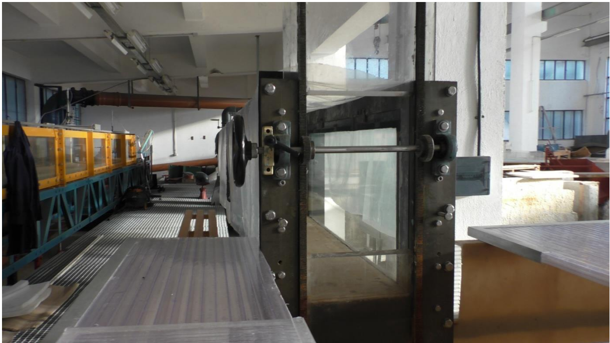
Εικόνα 4.11 Ορθογωνικός καθολικός υπερχειλιστής λεπτής στέψης κατάντη του καταβαθμού για τον έλεγχο των κατάντη συνθηκών ροής.
