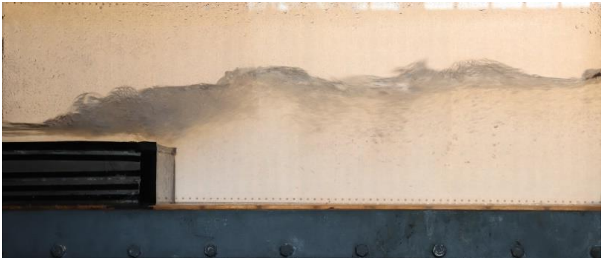
Εικόνα 1.5 Υπερκρίσιμη ροή ανάντη, υποκρίσιμη ροή κατάντη, A jump.
