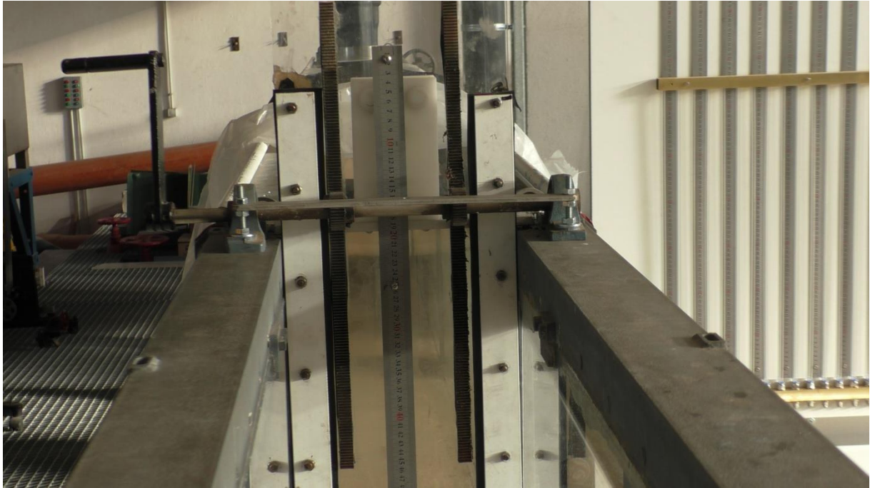
Εικόνα 4.10 Λεπτό κατακόρυφο θυρόφραγμα οξείας αιχμής ανάντη του καταβαθμού για τον έλεγχο των ανάντη συνθηκών ροής.
