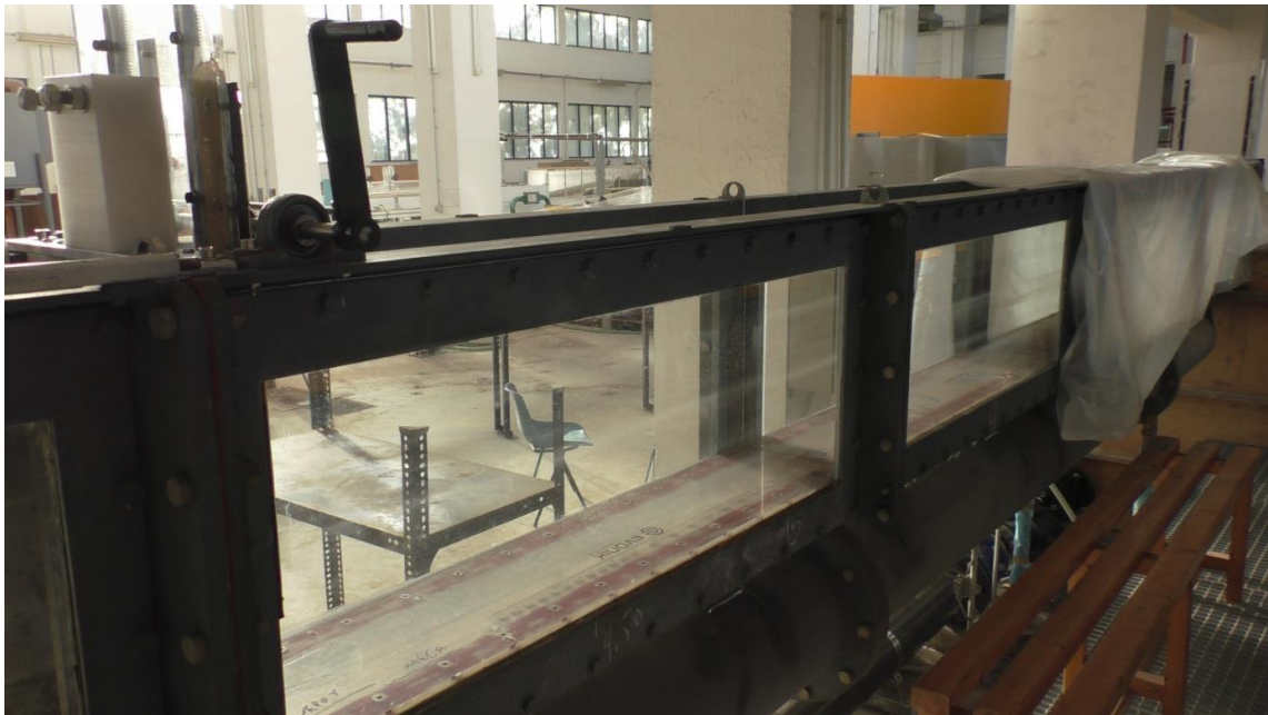
Εικόνα 4.4 Αντικατάσταση τμήματος του αδιαφανούς πυθμένα της διώρυγας με διαφανή και των παλαιών κατακόρυφων υαλοπινάκων της διώρυγας με νέους υαλοπίνακες εξαιρετικής καθαρότητας και αντοχής.
