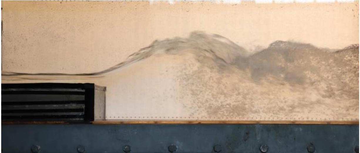
Εικόνα 1.4 Υπερκρίσιμη ροή ανάντη, υποκρίσιμη ροή κατάντη, Wave jump.
