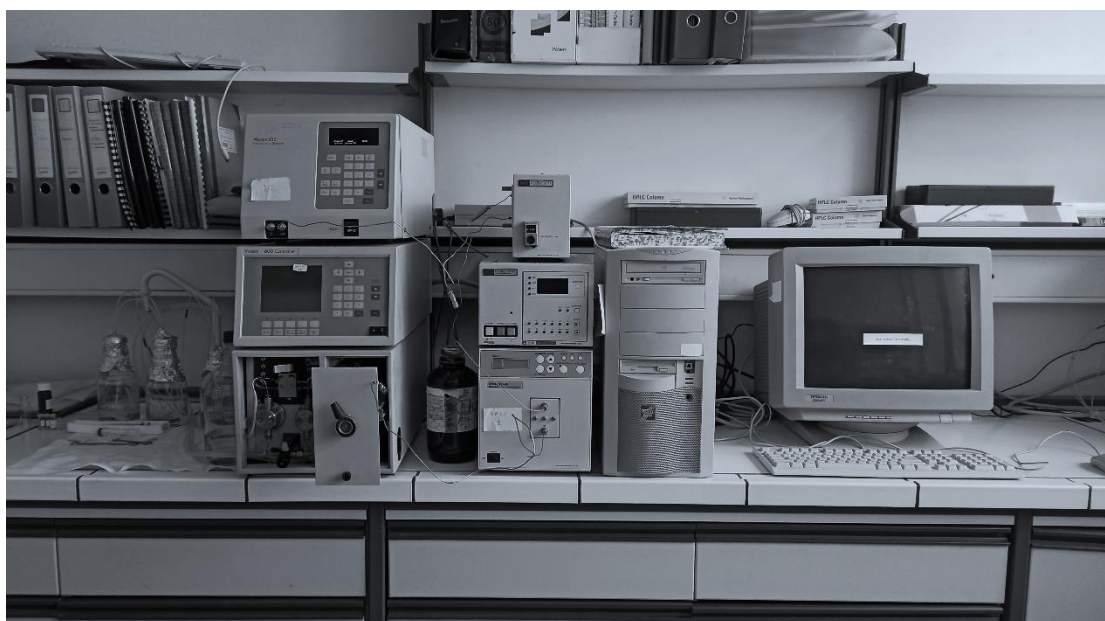
Εικόνα 12: Η διάταξη LC-FL στο εργαστήριο
