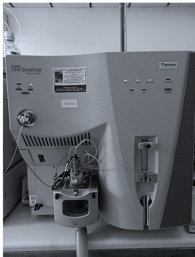
Εικόνα 14: Η διάταξη LC-MS/MS στο εργαστήριο
