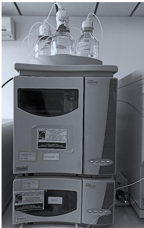
Εικόνα 14: Η διάταξη LC-MS/MS στο εργαστήριο
