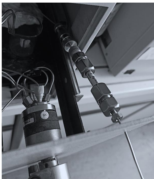
Εικόνα 13: Η στήλη και η προστήλη που χρησιμοποιήθηκαν στην διάταξη LC-FL
