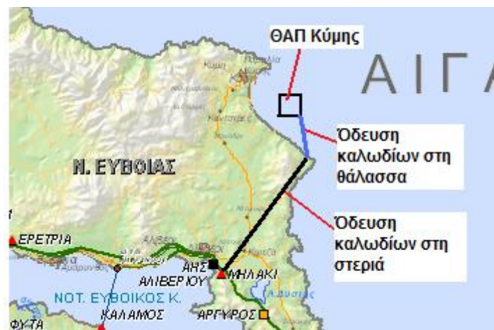
Εικόνα 5.46: Διασύνδεση ΘΑΠ Κύμης με το Σύστημα Μεταφοράς Ενέργειας (Πηγή: Δ.Ε.Σ.Μ.Η.Ε., 2011)
