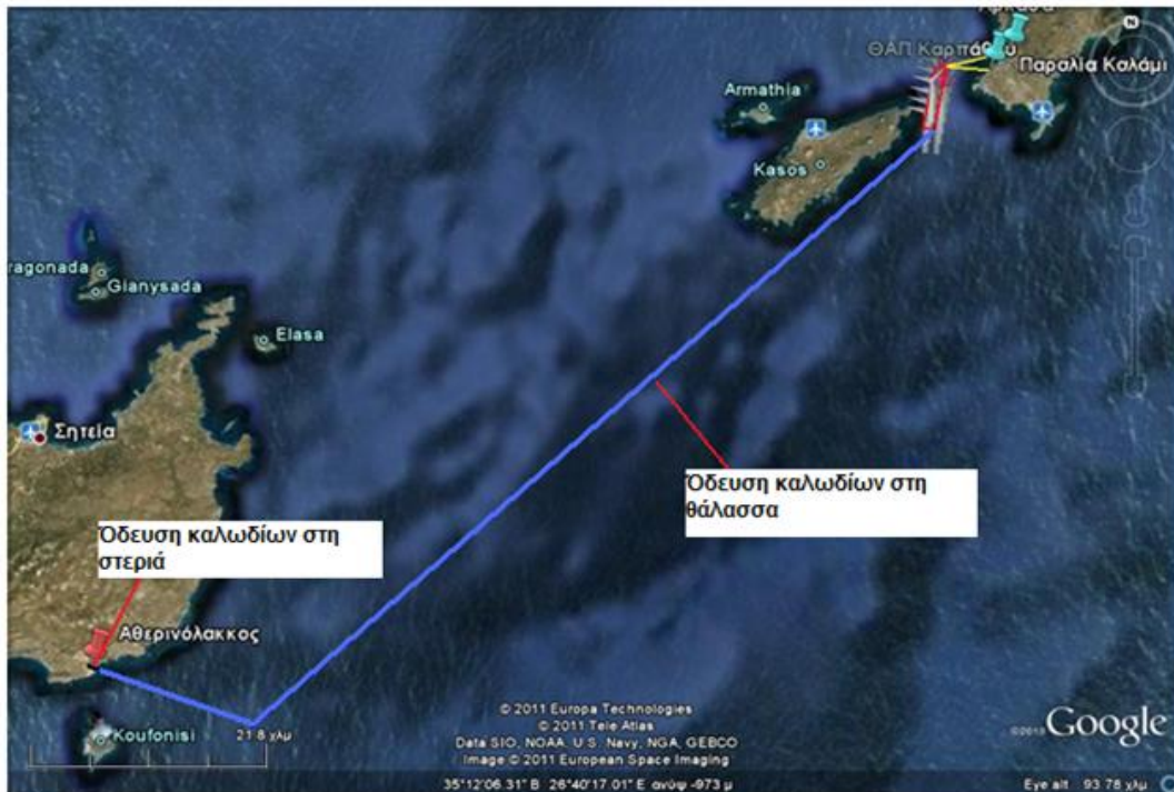
Εικόνα 5.61: Διασύνδεση ΘΑΠ Καρπάθου με το Σύστημα Μεταφοράς Ενέργειας (Πηγή: Google Earth, 2010)
