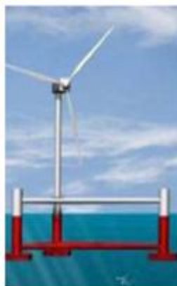
Εικόνα 3.15: Θεμελίωση Ημι-βυθιζόμενη (Πηγή: EWEA, 2009)
