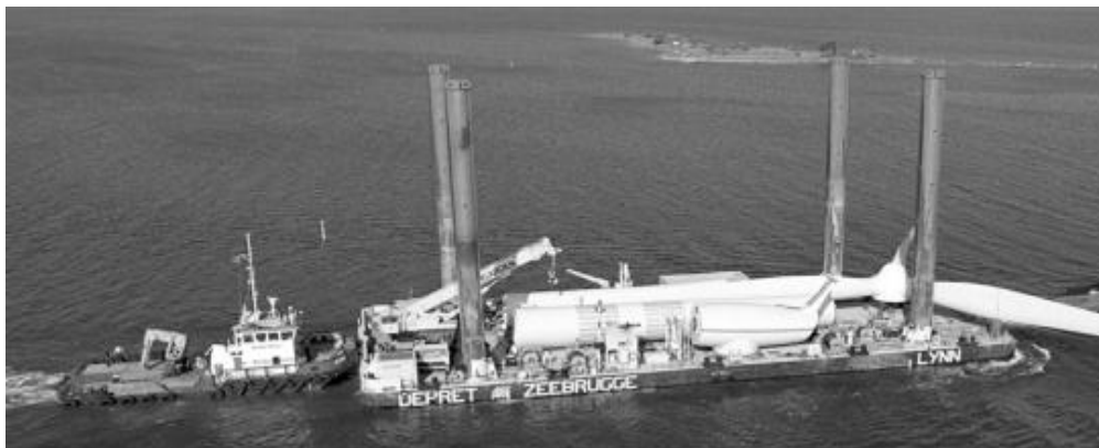
Εικόνα 5.42: Μεταφορά τμημάτων υπεράκτιας ανεμογεννήτριας (Πηγή: Γιαννακά, 2010)
