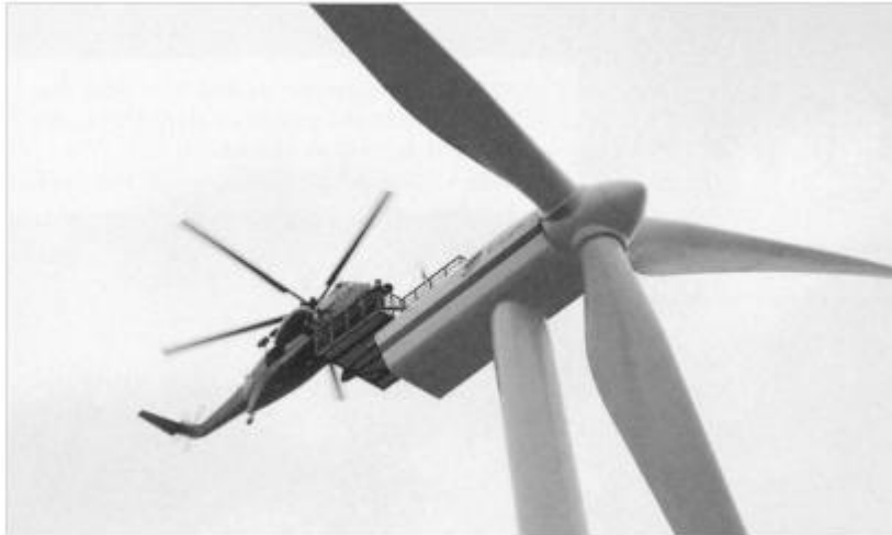
Εικόνα 3.7: Εναέρια πρόσβαση σε υπεράκτια ανεμογεννήτρια (Πηγή: Βραχίμης κ.α., 2010)
