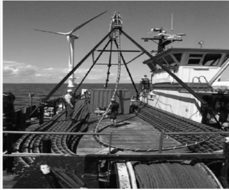
Εικόνα 5.40: Ειδικός εξοπλισμός τοποθέτησης καλωδίων (Πηγή: Βραχίμης κ.α., 2010)
