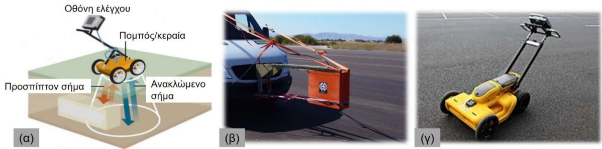
Εικόνα 3.2: (α) Αρχές λειτουργίας GPR, (β) πομπός σε απόσταση από την επιφάνεια ελέγχου και (γ) πομπός σε πλήρη επαφή με την επιφάνεια ελέγχου.
