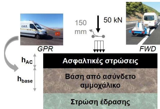
Εικόνα 6.2: Σχηματική απεικόνιση πειραματικής διαδικασίας σε τυπική διατομή οδοστρώματος.
