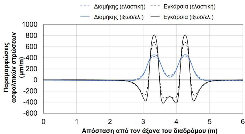
Εικόνα 9.8: Προφίλ οριζόντιων παραμορφώσεων στον πυθμένα των ασφαλιστικών στρώσεων για ελαστική και ιξωδοελαστική συμπεριφορά ασφαλτομιγμάτων.
