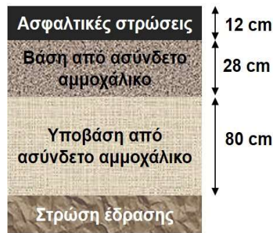
Εικόνα 9.4: Τυπική διατομή οδοστρώματος αεροδρομίου.
