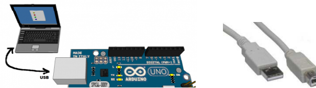
Εικόνα 18. Τροφοδοσία του Arduino μέσω της θύρας USB - τύπος Male A/B
