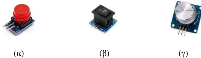
Εικόνα 33. Συσκευές Εισόδου α. Κουμπί β. Διακόπτης ON/OFF γ. Περιστροφικό ποτενσιόμετρο
