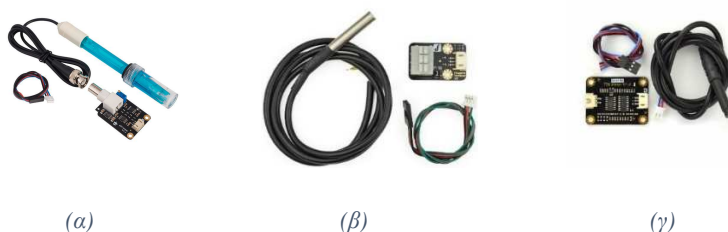
Εικόνα 68. (α) αισθητήρας pH (β) αισθητήρας θερμοκρασίας υγρών (γ) αισθητήρας TDS
