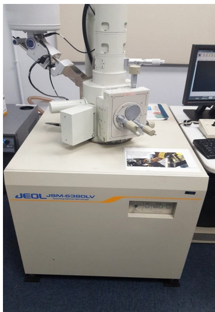
Εικόνα 8.7: Ηλεκτρονικό μικροσκόπιο σάρωσης JEOL 6380LV το οποίο βρίσκεται στο Εργαστήριο Ορυκτολογίας, Πετρολογίας και Κοιτασματολογίας της Σχολής Μεταλλειολόγων Μηχανικών του ΕΜΠ
