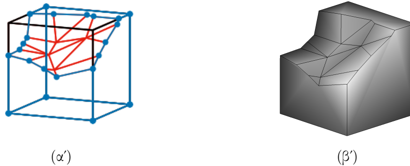
Σχήμα 2.7: (α) Σχηματισμός των εδρών της τεμνόμενης κυψέλης του σχήματος 2.6 που κείται εντός του ρέοντος ρευστού. (β') Τριδιάστατη απεικόνιση της τεμνόμενης κυψέλης.
