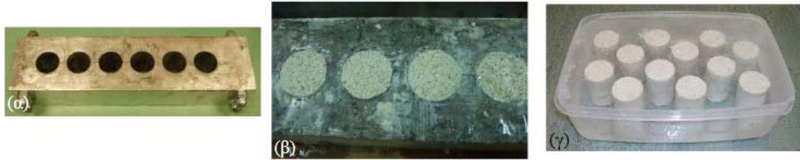
Εικ. 47. α) Τυπική μήτρα χύτευσης του κονιάματος, β) Κονίαμα μέσα στη μήτρα, γ) Συντήρηση δοκιμίων σε νερό. (Πηγή: Πάσιου, 2014).
