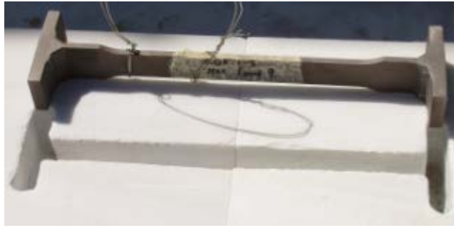
Εικ. 29. Σύνδεσμος τιτανίου μορφής διπλού «Τ» και η εντορμία εισαγωγής του. Πηγή: Πάσιου (2014)
