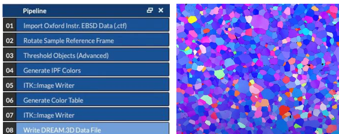
Εικόνα 31. Αρχιτεκτονική διάταξης για ερμηνεία δεδομένων EBSD και παραγωγή αρχείου .vti αρχείου στο λογισμικό DREAM3D [56]
