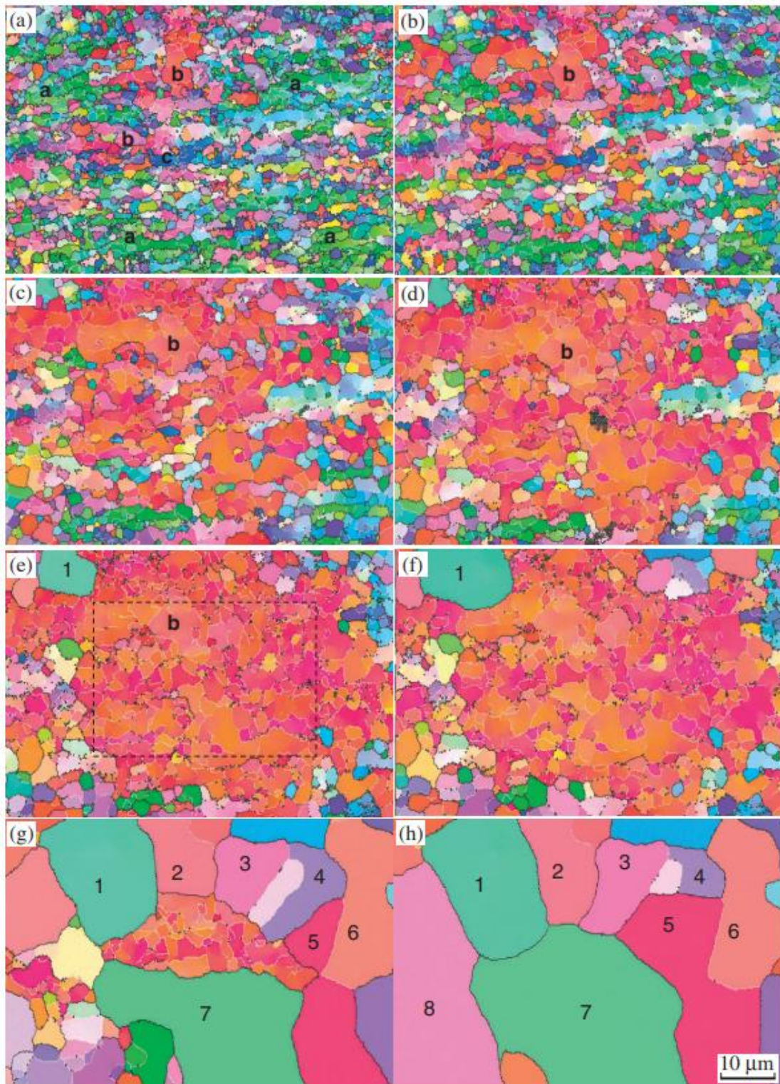
Εικόνα 17. Διαφορά μικροδομής ανάλογα με το χρόνο ανόπτησης (10, 20, 40, 60, 120, 240, 600, 1200 δευτερόλεπτα αντίστοιχα) σε κράμα Al-Mg-Si [30]
