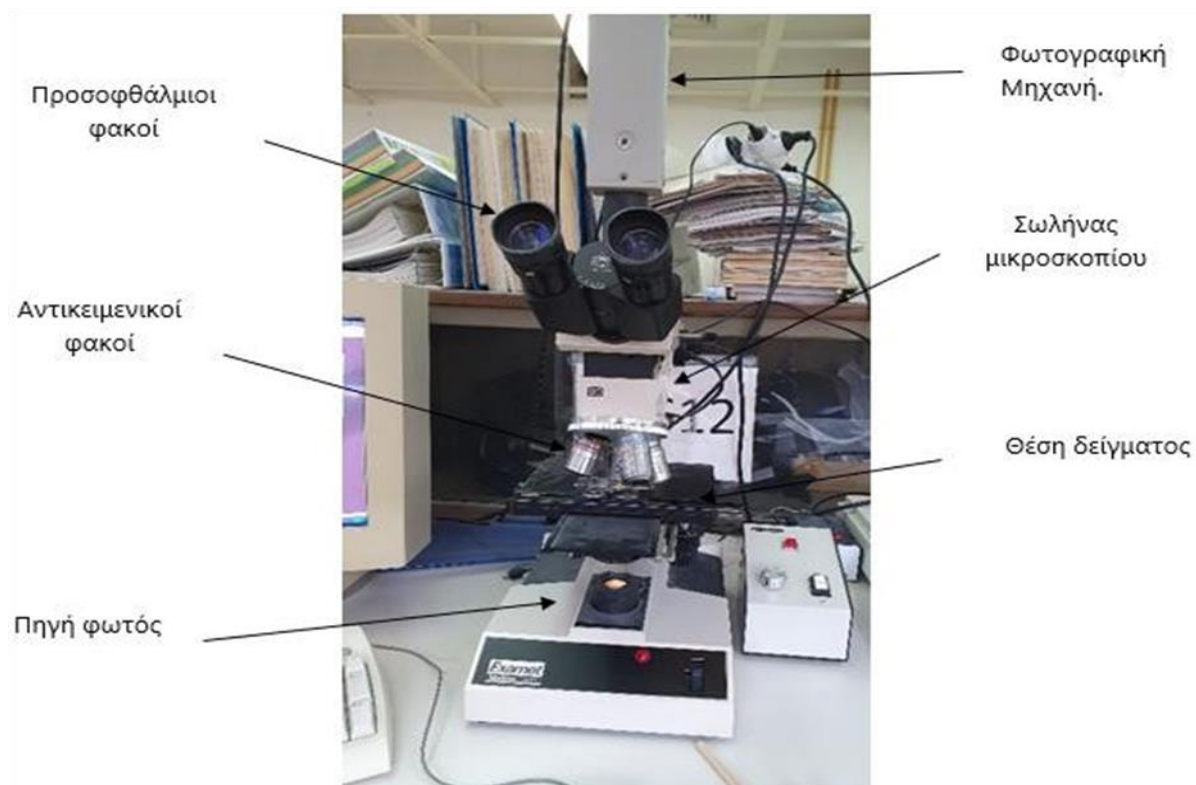
Εικόνα 3.7: Απεικόνιση διάταξης οπτικού μικροσκοπίου
