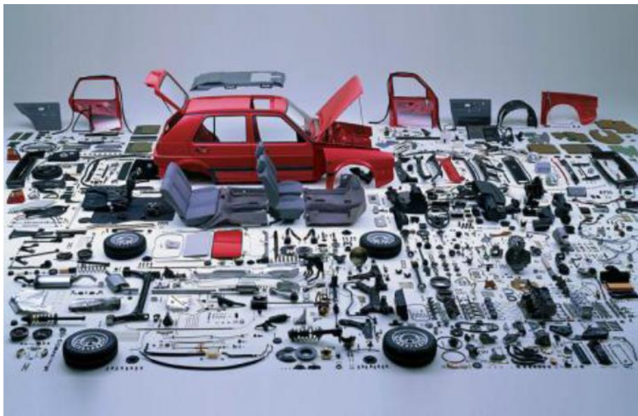
Εικόνα 1.2: Μέρη από τα οποία αποτελείται ένα αυτοκίνητο
