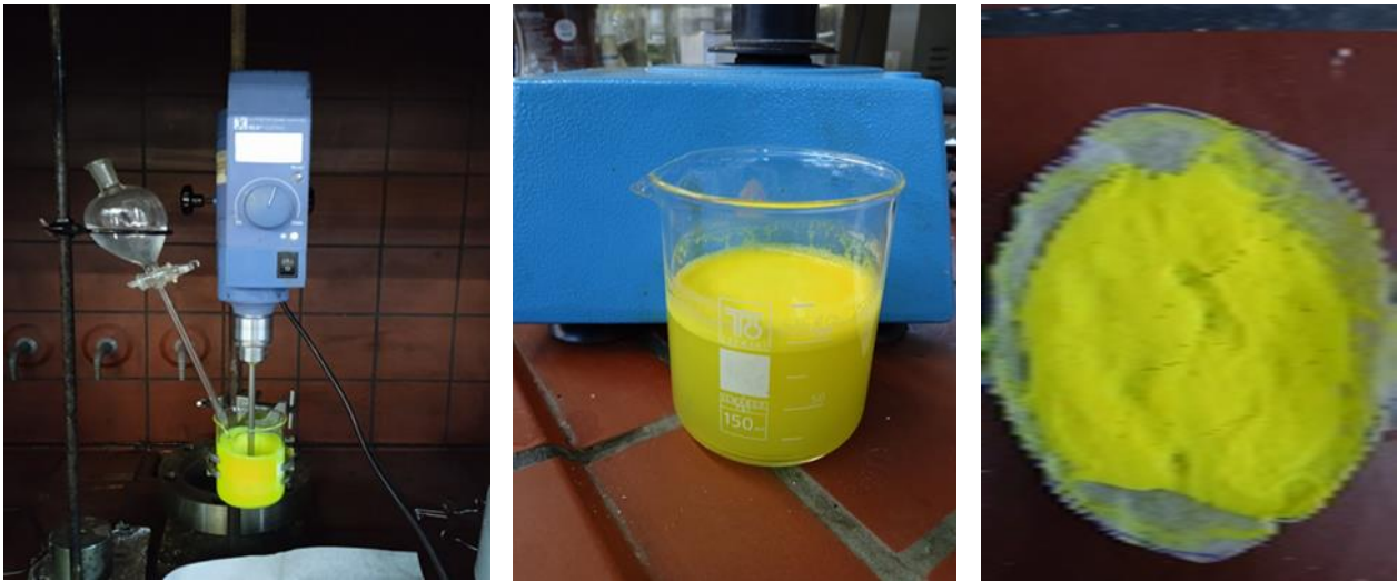
Εικόνα 3.5: Απεικόνιση πειράματος εγκλεισμού κουμαρίνης
