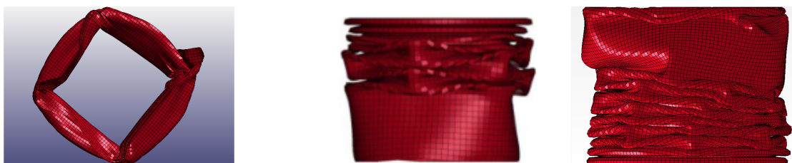
Σχήμα 5.8: Αρχή σχηματισμού diamond 4D λοβού στο μοντέλο αντίστοιχο του "3" (κέντρο), Τελική μορφή μοντέλου κλειστής διατομής αντίστοιχου του "2", (αριστερά) τελική μορφή μοντέλου σπειροειδούς διατομής "2" με συνεχή ραφή στην εξωτερική σπείρα.
