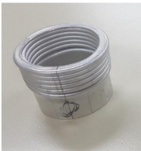
Σχήμα 3.4: Αξονοσυμμετρικός τρόπος κατάρρευσης με την δομή του δοκιμίου κυκλικής διατομής μετά την επιβολή θλιπτικού φορτίου [34]
