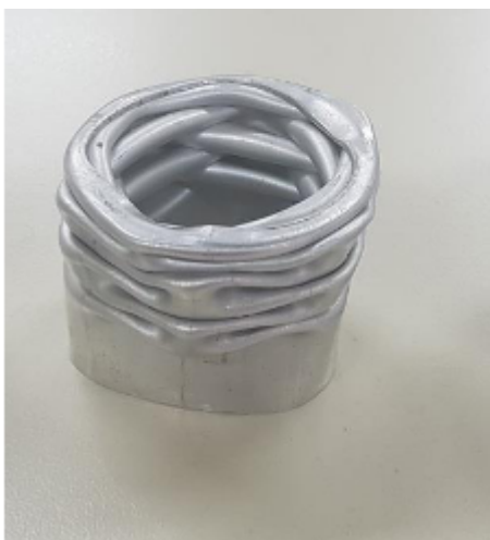
Σχήμα 3.6: Μη αξονοσυμμετρικός τρόπος κατάρρευσης (diamond mode) [34]
