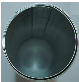
Σχήμα 2.8: Παράδειγμα δοκιμίου πολλαπλών τοιχωμάτων κυκλικής διατομής σε κάτοψη [34]
