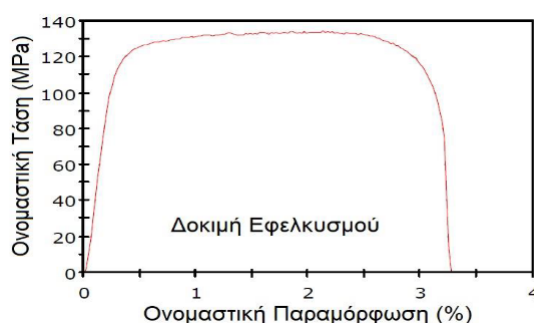
Σχήμα 4.3: Καμπύλη τάσης-πλαστικής παραμόρφωσης( \sigma - \epsilon ) κράματος αλουμινίου 6065-T5 [34]
