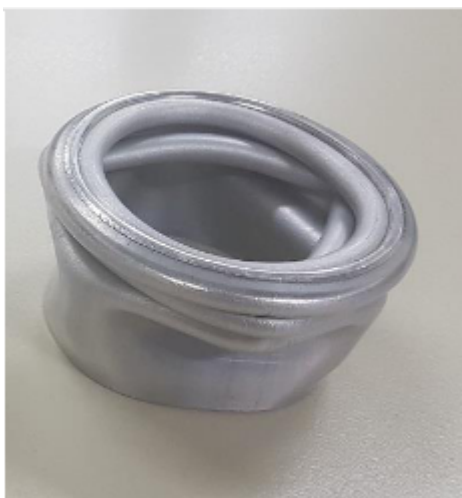
Σχήμα 3.7: Μικτός τρόπος κατάρρευσης [34]
