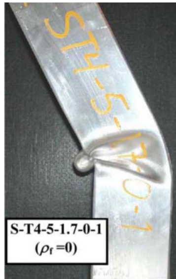
Σχήμα 2.6: Μορφή παραμόρφωσης σωλήνα αλουμινίου τετραγωνικής διατομής που υπόκειται σε λοξή φόρτιση γωνίας 5° [30]
