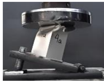
Εικόνα 8.3: Στιγμιότυπα κατάρρευσης δοκιμίων (ομάδα 3) και μοντέλου (dokimio_3)
