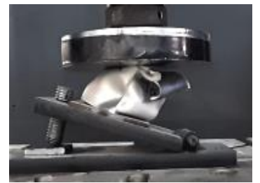
Εικόνα 8.3: Στιγμιότυπα κατάρρευσης δοκιμίων (ομάδα 3) και μοντέλου (dokimio_3)
