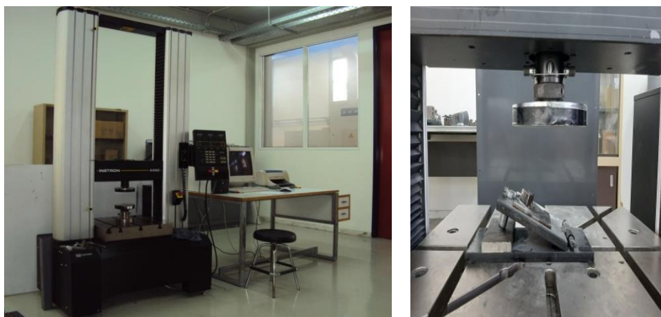
Εικόνα 6.2: (Δεξιά) Η πειραματική διάταξη που βρίσκεται στις εγκαταστάσεις του εργαστηρίου Κατεργασιώντων Υλικών του ΕΜΠ. (Αριστερά) Τα εργαλεία θλίψης της INSTRON 4482.
