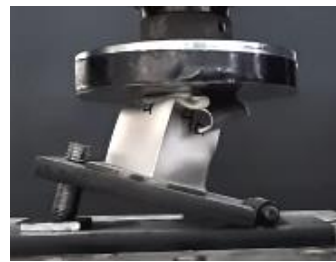
Εικόνα 8.3: Στιγμιότυπα κατάρρευσης δοκιμίων (ομάδα 3) και μοντέλου (dokimio_3)
