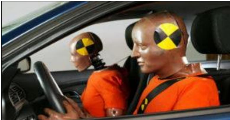
Εικόνα 2.1: Ανδρείκελα στην προσομοίωση σύγκρουσης. [8]
