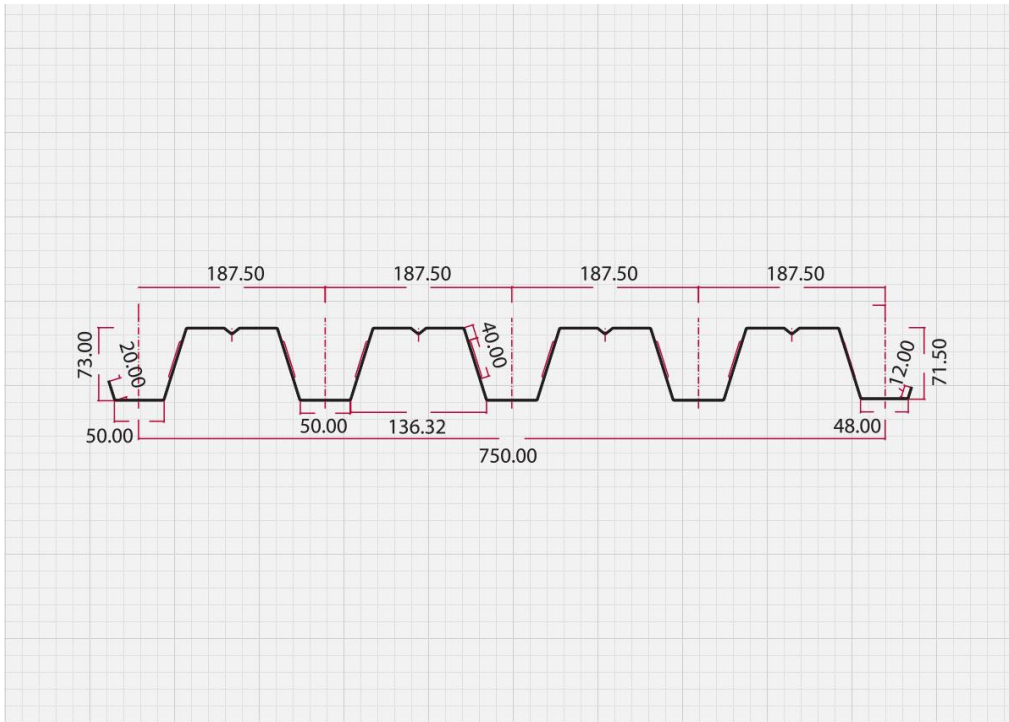
Εικόνα 1.3: Τεχνικό διάγραμμα SYMDECK 73. Πηγή: (ΕΛΑΣΤΡΟΝ Α.Ε.Β.Ε.)
