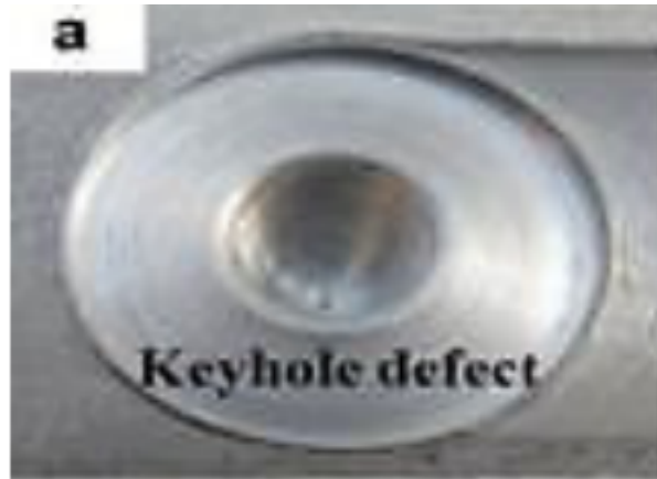
Εικόνα 44 Σχηματισμός Keyhole σε συγκόλληση ανόμοιων κραμάτων AA2219/AA7075 [100]
