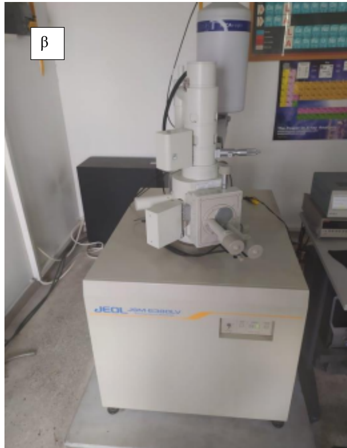
Εικόνα 60:α) Διάταξη ηλεκτρονικού μικροσκοπίου σάρωσης β) Ηλεκτρονικό μικροσκόπιο σάρωσης SEM του Εργαστηρίου Ορυκτολογίας Πετρολογίας-Κοιτασματολογίας τύπου Jeol JSM 6380LV
