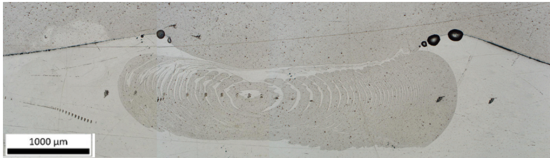
Εικόνα 72 Μικροσκοπική παρατήρηση του πυρήνα συγκόλλησης του δοκιμίου A7 σε μεγέθυνση x2,5 α) σε μεγέθυνση x5,0 γ) σε μεγέθυνση x5,0
