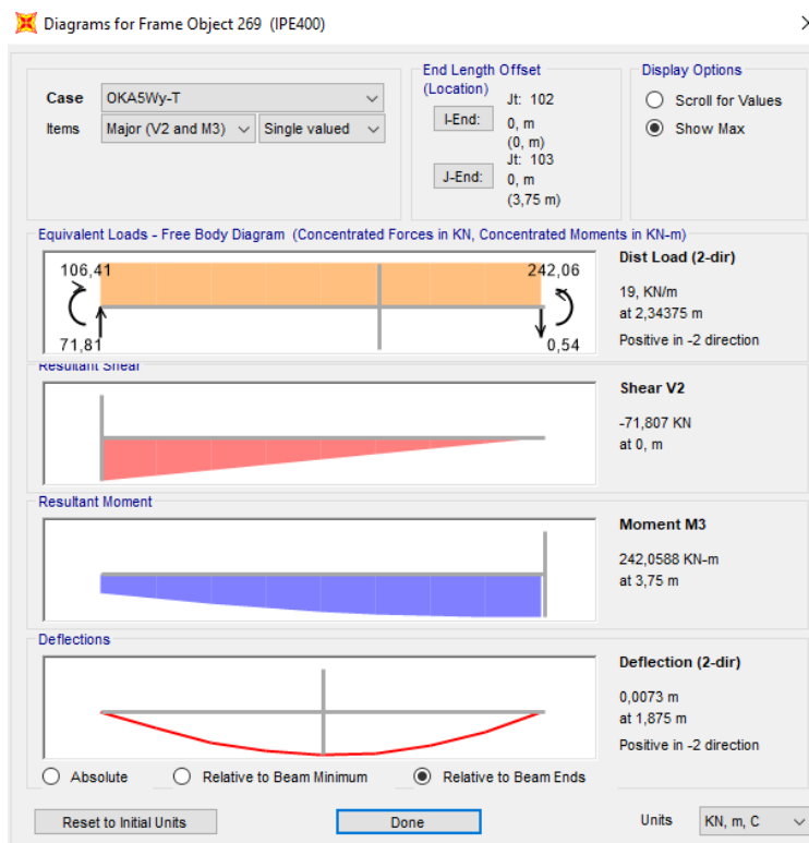
Εικόνα 89: Εντατικά μεγέθη μέλους για το συνδυασμό "OKAWy-T" από τη φάση ανάλυσης
