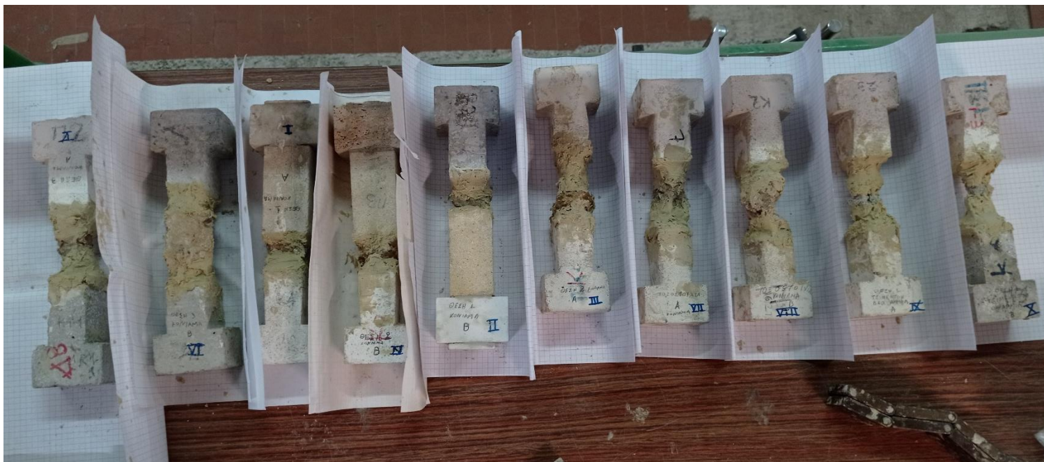
Εικόνα Γ1 Τα δοκίμια κονιαμάτων που ετοιμάστηκαν στο εργαστήριο για την δοκιμή εφελκυσμού
