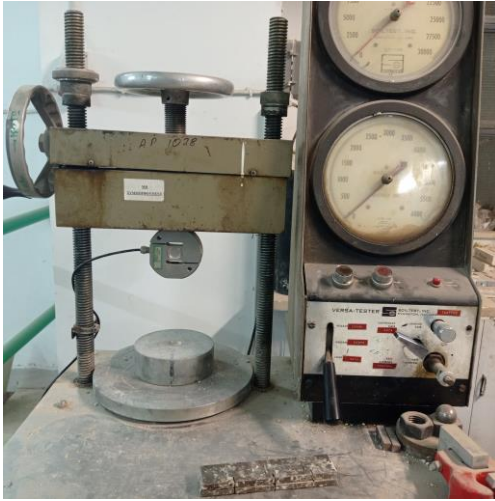
Εικόνα Γ2 Η μηχανή θλίψης που χρησιμοποιήθηκε
