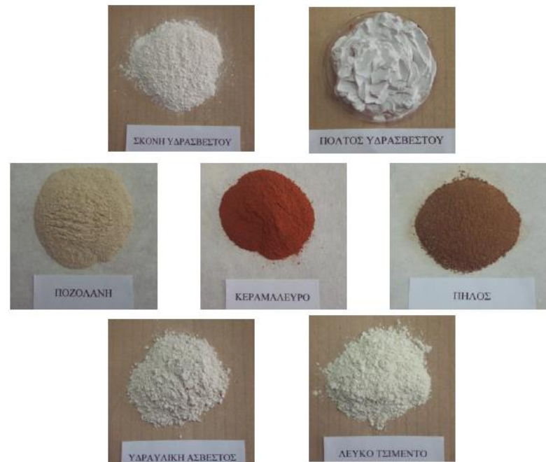
Εικόνα Δ1 Είδη κονιών με χρήση σε τοιχοποιία (πηγή: Διδακτικές Σημειώσεις «Δομικών υλικών Ι», ΑΠΘ)
