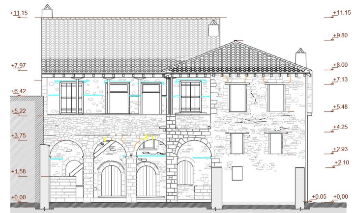
Σχήμα Β27 Βορειοανατολική όψη με επισήμανση ρωγμών
