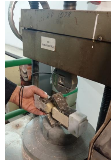
Εικόνα Γ7 Τοποθέτηση στη μηχανή θλίψης
