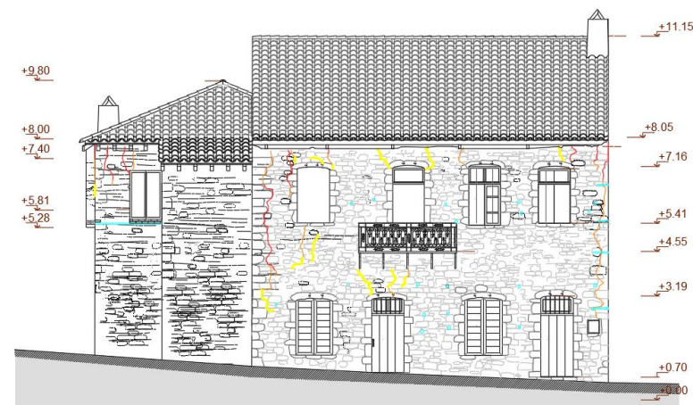
Σχήμα Β26 Νοτιοδυτική όψη με επισήμανση ρωγμών
