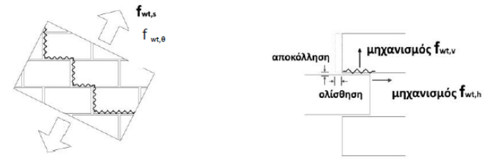
Σχήμα Γ5 Μηχανισμός αστοχίας τοιχοποιίας υπό λοξό εφελκυσμό (ΚΑΔΕΤ Σ4)
