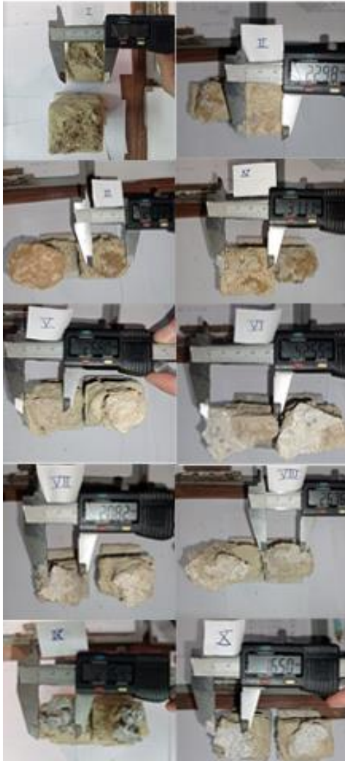
Εικόνα Γ8 Επιφάνειες θραύσης δοκιμών Ι έως Χ
