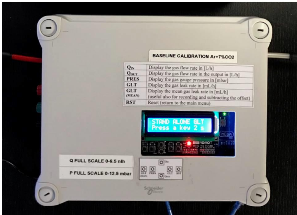
ΕΙΚΟΝΑ [68]: ΦΩΤΟΓΡΑΦΙΑ ΑΠΟ ΤΟ ΕΣΩΤΕΡΙΚΟ ΤΗΣ SA-GLT-1 ΌΠΟΥ ΦΑΙΝΕΤΑΙ Η LCD ΟΘΟΝΗ ΜΕ ΤΟ ΚΕΥΡΑΔ.
