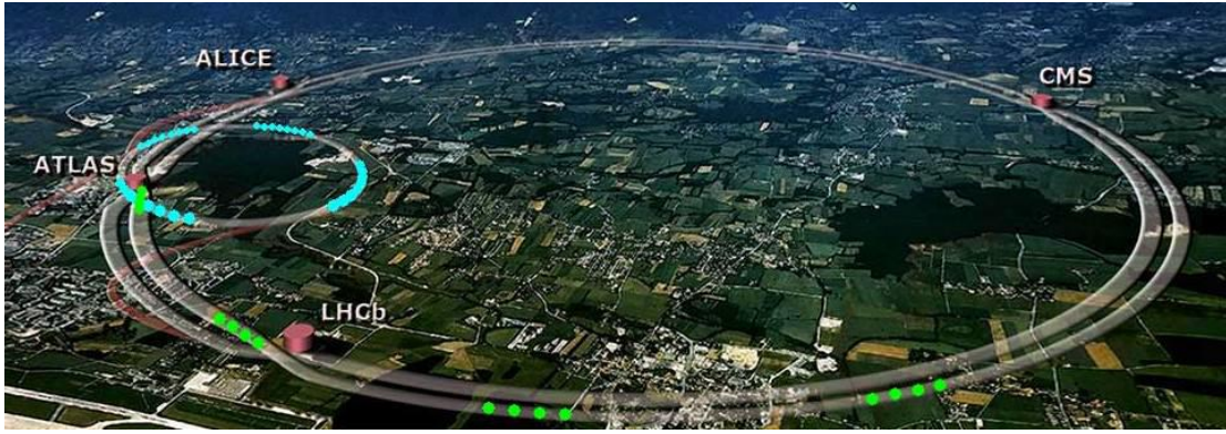
ΕΙΚΟΝΑ [1]: ΣΧΗΜΑΤΙΚΗ ΑΝΑΠΑΡΑΣΤΑΣΗ ΕΠΙΤΑΧΥΝΤΩΝ ΚΑΙ ΕΡΓΑΣΤΗΡΙΩΝ ΤΟΥ LHC. Ο 27 Μ ΔΑΚΤΥΛΙΟΣ ΤΡΟΦΟΔΟΤΕΙΤΕ ΜΕ ΔΕΣΜΕΣ ΣΩΜΑΤΙΔΙΩΝ ΣΤΟΝ ΟΠΟΙΟ ΣΥΓΚΡΟΥΝΤΑΙ ΣΤΑ ΣΗΜΕΙΑ ΠΟΥ ΕΙΝΑΙ ΤΟΠΟΘΕΤΗΜΕΝΑ ΤΑ 4 ΥΠΟΓΕΙΑ ΠΕΙΡΑΜΑΤΑ ATLAS, CMS, ALICE & LHCb.
