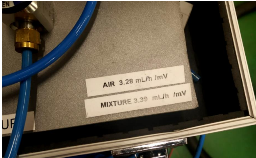
ΕΙΚΟΝΑ [79]: ΣΤΑΘΕΡΕΣ ΑΕΡΙΩΝ ΠΑΝΩ ΣΤΗΝ ΦΟΡΗΤΗ ΔΙΑΤΑΞΗ.
