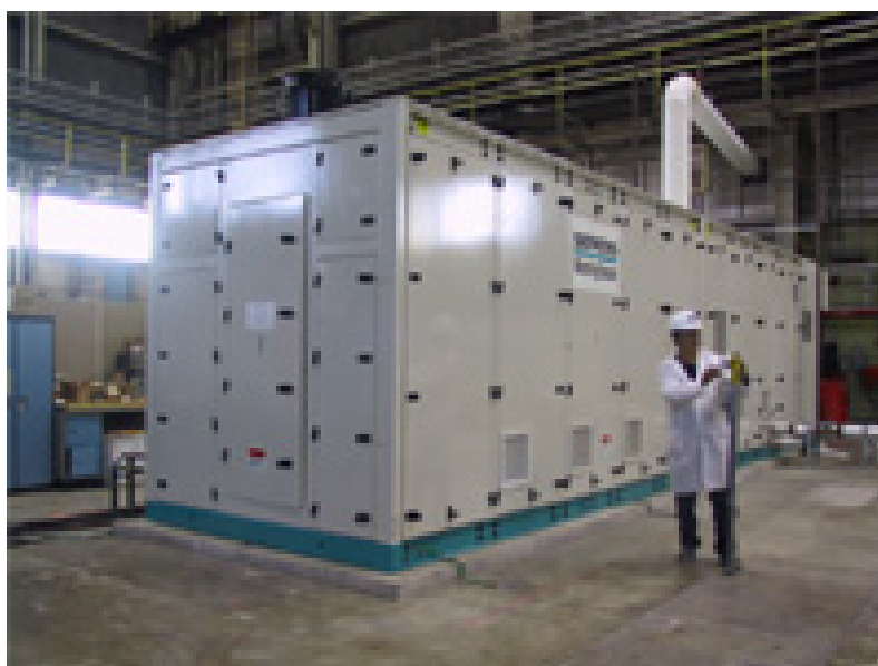
Εικόνα 2.3 Η μεγαλύτερη ατμοσφαιρική κυψέλη καυσίμου που έχει κατασκευαστεί τεχνολογίας SOFC ισχύος 250 kW CHP (Combined Heat Power)
