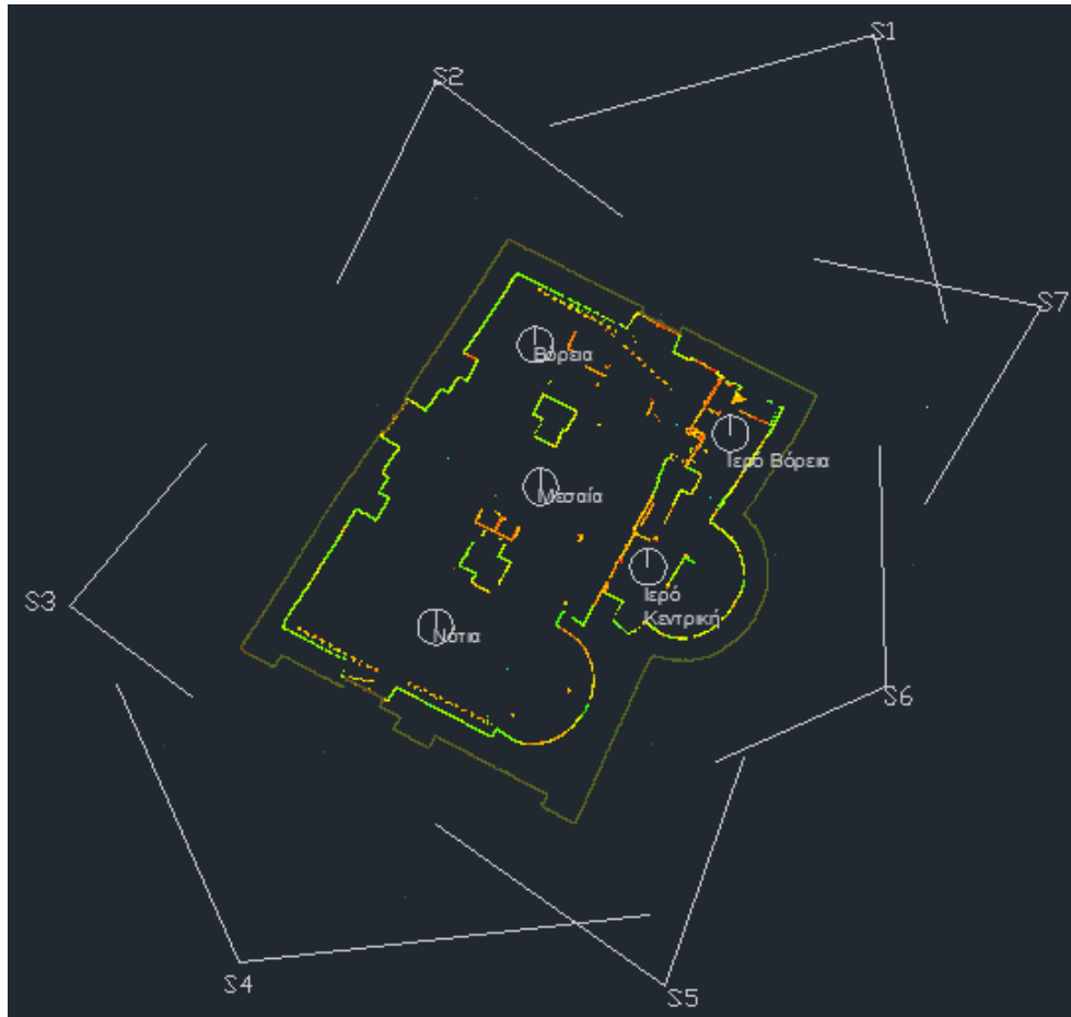
Εικόνα 3.1: Σκαρίφημα με τις θέσεις του σαρωτή και το άνοιγμά του. Το σκαρίφημα προέρχεται από τις τομές που προέκυψαν από το λογισμικό Cyclone.
