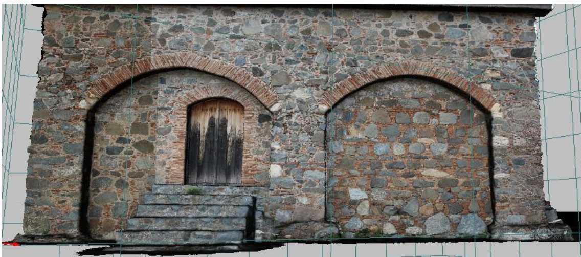
Εικόνα 5.9: Απόδοση της υφής στην νότια όψη. Η εικόνα που προέκυψε από το λογισμικό προέρχεται από δύο εικόνες με διαφορετική ραδιομετρία, ενώ η γεωμετρία είναι ορθή.
