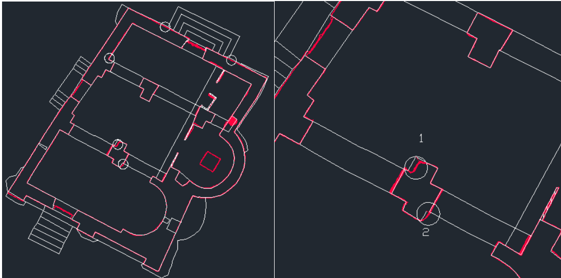
Εικόνα 6.3 & 6.4: Οι οριζόντιες τομές όπως προέκυψαν από τις τοπογραφικές μετρήσεις (λευκό) και από το λογισμικό Geomatic (ροζ) σε επίθεση. Τα δύο περιγράμματα ταυτίζονται, οι περιοχές που υπάρχουν αποκλίσεις επισημαίνονται με κύκλους. Εικόνα 6.4: Σημεία με μεγάλη απόκλιση που οφείλονται στην έλλειψη πληροφορίας (σημείων) με αποτέλεσμα την λανθασμένη δημιουργία των τριγώνων. Στην 1 η περίπτωση η απόκλιση ισούται με 14cm, και στην 2 η 7.3cm
