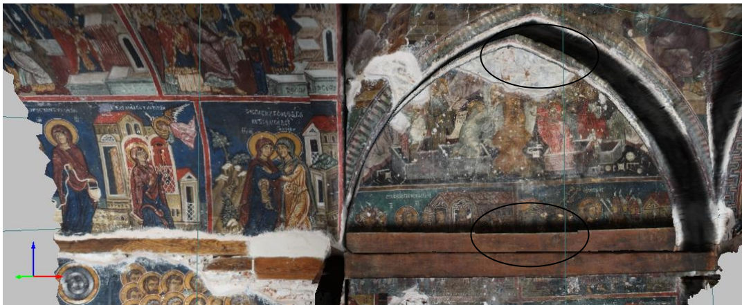
Εικόνα 5.10: Απόδοση της υφής στο μεσαίο κλίτος, στα σημεία όπου αποκρύπτονται στην γωνία θέασης προβάλλεται λάθος χρώμα. Τα λάθη επισημαίνονται με κύκλους .
