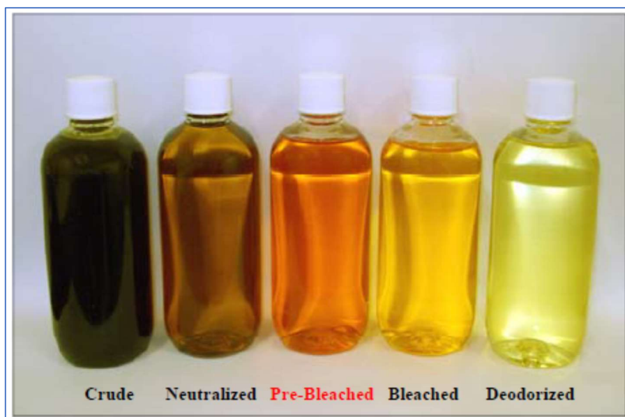
Εικόνα 5: Μεταβολή χρώματος φυτικού ελαίου μετά από κάθε στάδιο του εξευγενισμού (Αρχικό έλαιο- Εξουδετερωμένο- Αποχρωματισμένο- Αποσμημένο), Από (CROWN IRON WORKS, 'Double pass bleaching system', Minneapolis, USA, (Accessed 03.01.2022)).
