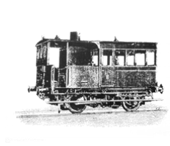
1 ατμήλατη αυτοκινητάμαξα τροχιόδρομου Serpollet WEIDKNECHT (ΓΑΛΛΙΑ) πρότυπο για την παραγγελία του ντε Κίρικο το 1895 με στόχο την ενσωμάτωση στον τροχιόδρομο
