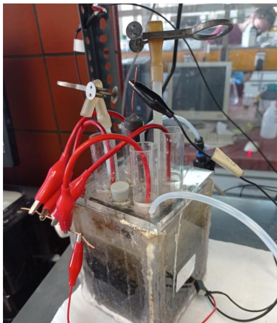
Εικόνα 14: Τυπική Μικροβιακή Κυψελίδα Καυσίμου εν λειτουργία, όπου φαίνεται η σύνδεση των ηλεκτροδίων στο καταγραφικό της τάσης
