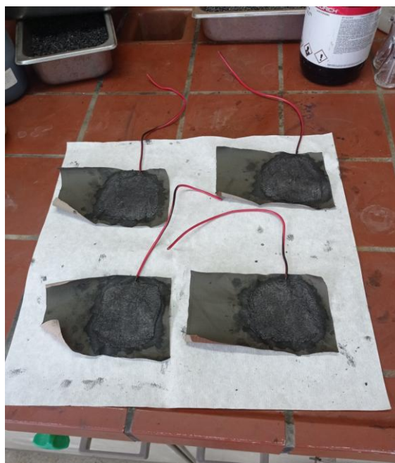
Εικόνα 17: Επικάλυψη υφάσματος Gore-Tex με αγωγή πάστα.
