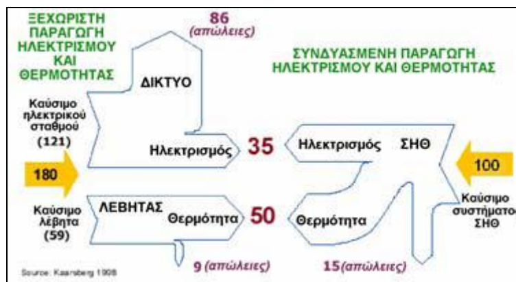
Σχήμα 1.4. Συμβατικό ενεργειακό σύστημα σε σύγκριση με σύστημα συμπαραγωγής.
