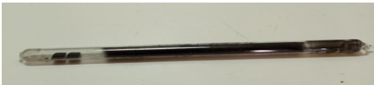
Εικόνα 5.7: Ο σωλήνας χαλαζία και τα υποστρώματα SiO 2 μετά την ολοκλήρωση της διαδικασίας θερμόλυσης
