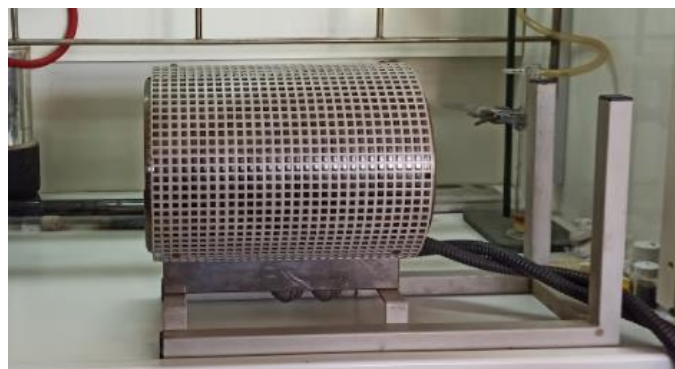
Εικόνα 5.6: Ο φούρνος εντός του οποίου τοποθετείται ο σωλήνας χαλαζία με σκοπό την διεξαγωγή της διαδικασίας θερμόλυσης.
