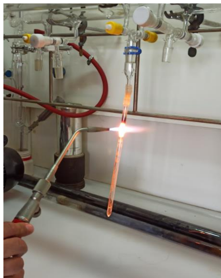
Εικόνα 5.5: Διαδικασία οξυγονοκόλλησης με σκοπό την σφράγιση του σωλήνα χαλαζία.
