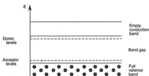
Σχήμα 3.10: Σχηματικό διάγραμμα δομής ζωνών σε έναν ημιαγωγό προσμίξεων [72]
