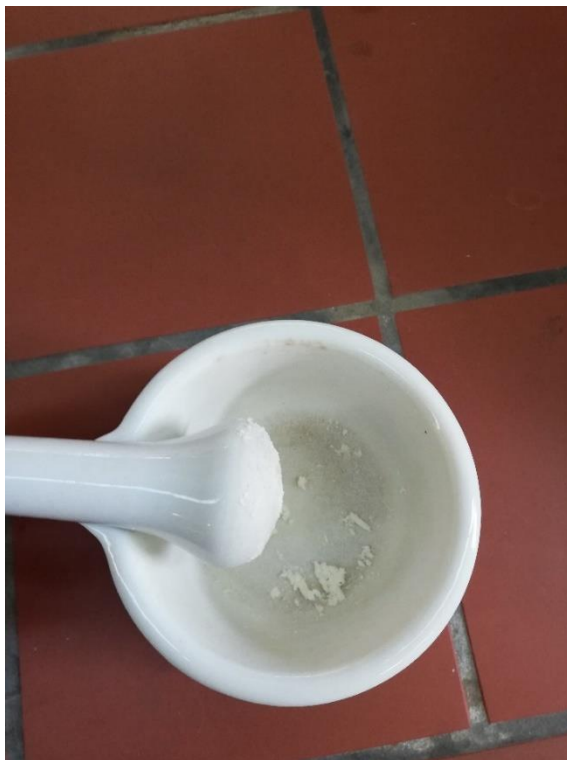
Εικόνα 3.15 Θρυμμάτισμα μικροκαψουλών σε γουδί.
