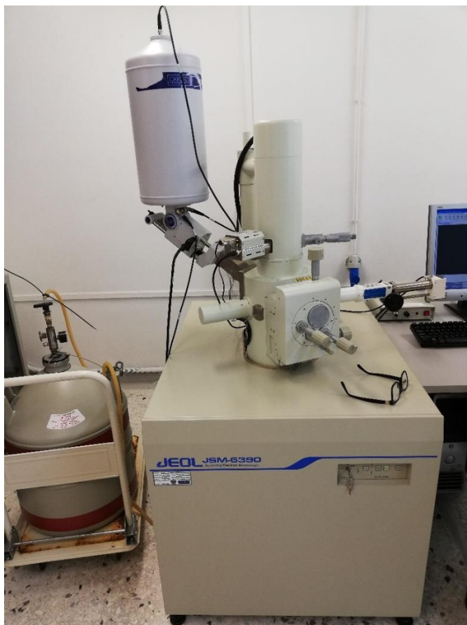
Εικόνα 3.8 Όργανο SEM JEOL JSM-6390.
