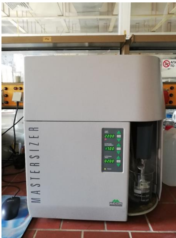
Εικόνα 3.11 Όργανο Laser Malvern Mastersizer Micro 2000.
