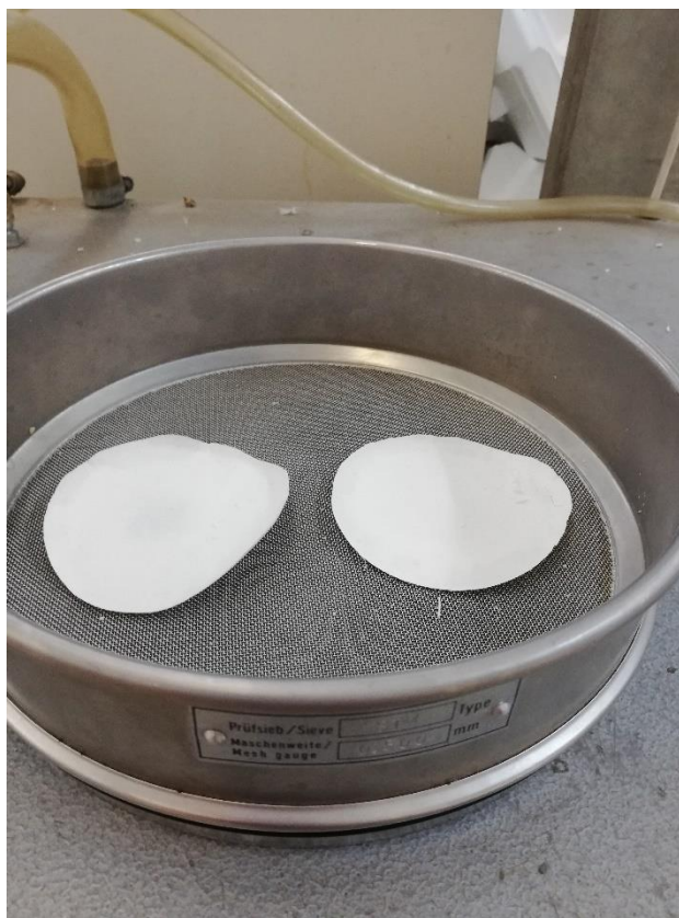
Εικόνα 3.4 Ξήρανση δείγματος έπειτα από τη διήθηση.
