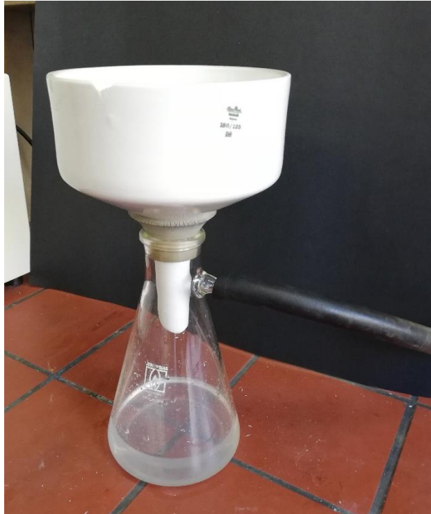
Εικόνα 3.3 Απεικόνιση διάταξης διήθησης υπό κενό.
