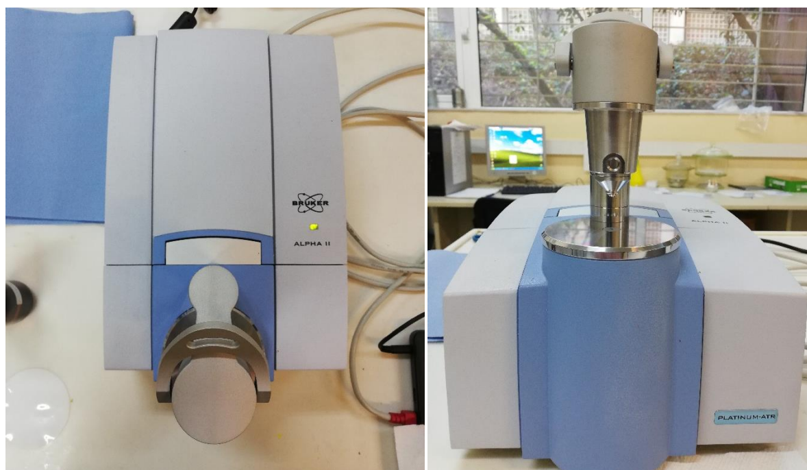
Εικόνα 3.14 Όργανο ALPHA II και το εξάρτημα PLATINUM ATR.
