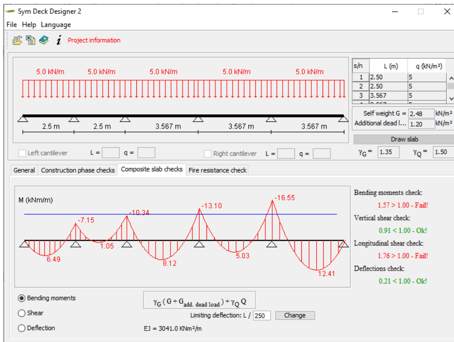
Εικόνα 4. 6 Έλεγχοι στη φάση λειτουργίας
