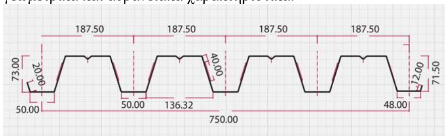
Εικόνα 4. 3 Γεωμετρικά χαρακτηριστικά χαλυβδόφυλλου SYMDECK-73
