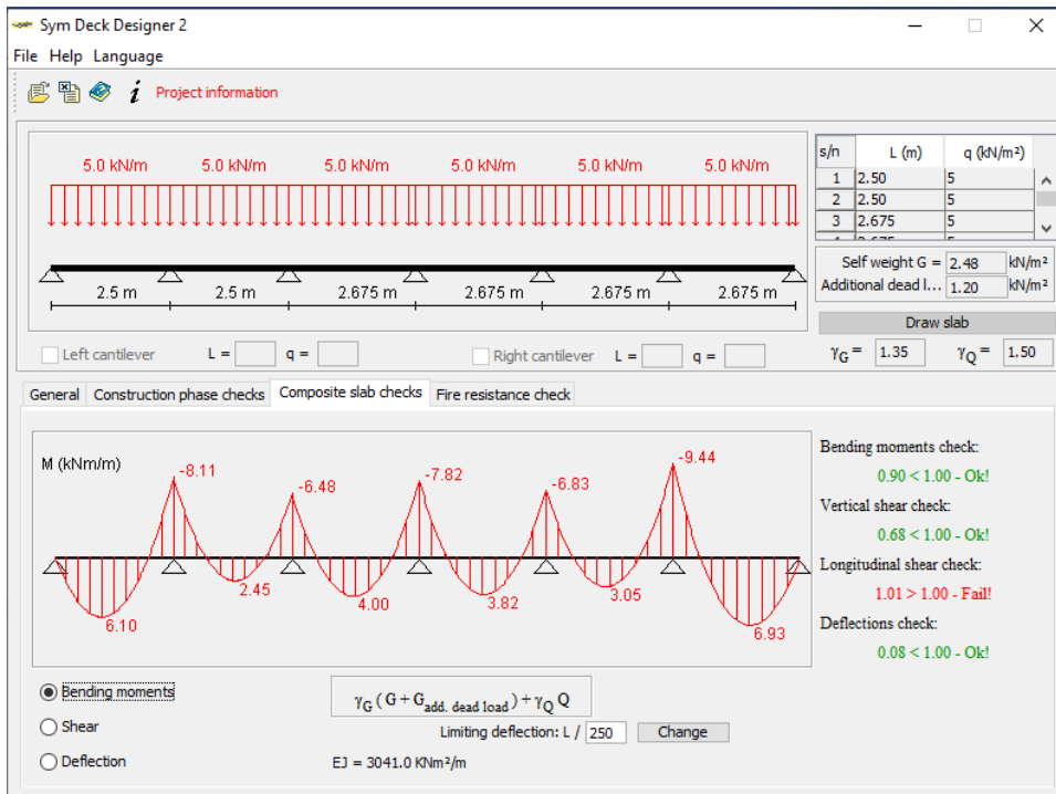
Εικόνα 4. 9 Έλεγχοι στη φάση λειτουργίας
