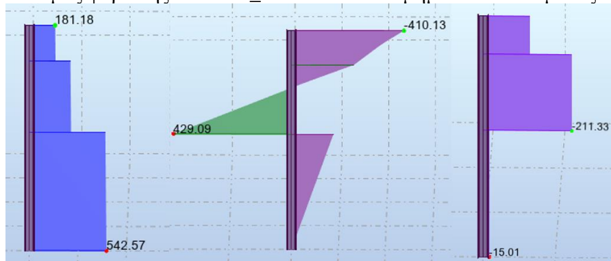
Εικόνα 4. 42 Εντατικά μεγέθη Αξονικής (αριστερά) Ροπής (κέντρο) και Τέμνουσας (δεξιά) για τον COMB3_SEISM
